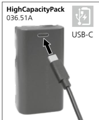
! Der Akku darf **nur** mit dem beiliegenden Ladegerät aufgeladen und ausschließlich mit **diesem** Lasergerät verwendet werden. Ansonsten besteht Verletzungs- und Brandgefahr. (3G Pro)
