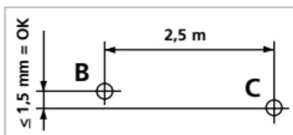
**!** Před použitím, po přepravě a po dlouhém skladování pravidelně kontrolujte kalibraci.
