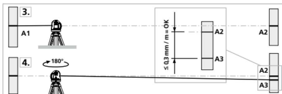
**!** Pokud jsou body A2 a A3 od sebe vzdáleny více než  $0,3 \text{ mm / m}$ , je nutné provést kalibraci. Spojte se s Vaším specializovaným prodejcem nebo využijte servisního oddělení společnosti UMAREX-LASERLINER.
