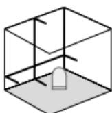
Avaa kuljetusvarmistus, siirrä liukukytkin (2) oikealle. Laserristi näkyy.
