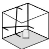
Přepravní pojistku neuvolňujte, posuvný vypínač (2) posuňte doleva. Laser zapněte tlačítkem ZAP./VYP. Nyní je možné zalícit šikmé roviny. V tomto režimu není možné provádět horizontální resp. vertikální nivelaci, protože linie laseru se již automaticky nevyrovnávají. Laserové linky blikají zeleně.
