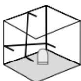
Non allentare la sicurezza di trasporto, spostare l'interruttore a scorrimento (2) verso sinistra. È ora possibile tracciare piani inclinati. In questa modalità non si può livellare orizzontalmente o verticalmente, in quanto le linee laser non si orientano più automaticamente. Le linee laser lampeggiano in verde.
