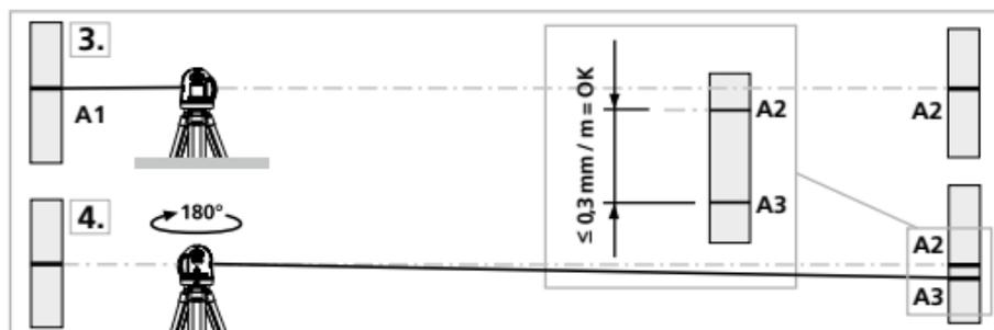
**!** Quand A2 et A3 sont distants de plus de 0,3 mm / m l'un de l'autre, un réglage de l'appareil est nécessaire. Prenez contact avec votre revendeur ou appelez le service après-vente de UMAREX-LASERLINER.
