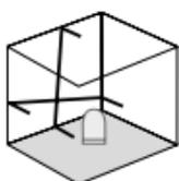
Die Transportsicherung nicht lösen, Schiebeschalter (2) nach links schieben. Die Laser mit der AN/AUS-Taste anschalten. Jetzt können schiefe Ebenen angelegt werden. In diesem Modus kann nicht horizontal bzw. vertikal nivelliert werden, da sich die Laserlinien nicht mehr automatisch ausrichten. Die Laserlinien blinken grün.
