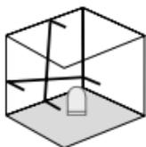
Під час транспортування не знімати блокуючий елемент, вимикач (2) перевести в ліве положення. Увімкнути лазер за допомогою кнопки УВІМК/ВИМК. Тепер можна будувати похилі площини. У цьому режимі не можна здійснити горизонтальне або вертикальне нівелювання, тому що лазерні лінії вже автоматично не вирівнюються. Блимають зелені лазерні лінії
