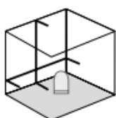
Uvolněte transportní pojistku, posuvný spínač (2) posuňte doprava. Objeví se laserový kříž.
