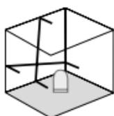
Prepravnú poistku neuvoľnite, posuvný vypínač (2) posuňte doľava. Laser zapnite tlačidlom ZAP./VYP. Teraz môžu byť vytvorené šikmé roviny. V tomto režime nie je možná horizontálna, resp. vertikálna nivelácia, pretože laserové línie sa už automaticky nenasmerujú. Laserové čiary blikajú na zeleno.
