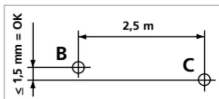
Сделайте отметку В на стене. Поворачивайте прибор, пока лазерный крест не сдвинется на 2,5 м вправо. Сделайте отметку С. Расстояние между горизонтальными линиями, проведенными через эти две точки, не должно превышать  $\pm 1,5$  мм. Повторите замеры, поворачивая прибор влево.
