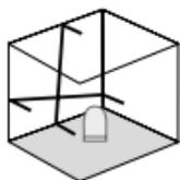
Lossa inte transportsäkringingen, och skjut strömbrytaren (2) åt vänster. Laserapparaten slås på med PÅ/AV-knappen. Nu kan lutande plan skapas. I detta läge kan inte horisontell eller vertikal nivellering göras, eftersom laserlinjerna inte längre justeras in automatiskt. LED (1) och laserlinjerna blinkar grönt.
