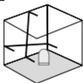
Ne pas dégager le blocage de transport, faire glisser l'interrupteur à coulisse (2) vers la gauche. Il est maintenant possible de travailler sur des plans inclinés. Il n'est pas possible d'effectuer un nivellement horizontal ou vertical dans ce mode étant donné que les lignes laser ne s'orientent plus automatiquement. Les lignes laser clignotent en vert.
