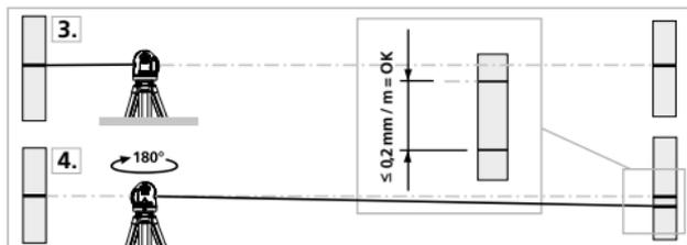
**!** Pokud jsou body A2 a A3 od sebe vzdáleny více než 0,2 mm / m, je nutné provést kalibraci. Spojte se s Vaším specializovaným prodejcem nebo využijte servisního oddělení společnosti UMAREX-LASERLINER.
