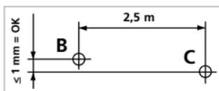
**!** Před použitím, po přepravě a po dlouhém skladování pravidelně kontrolujte kalibraci.
