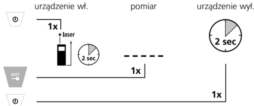
! Urządzenie uruchamia się po włączeniu pomiaru ciągłego.
