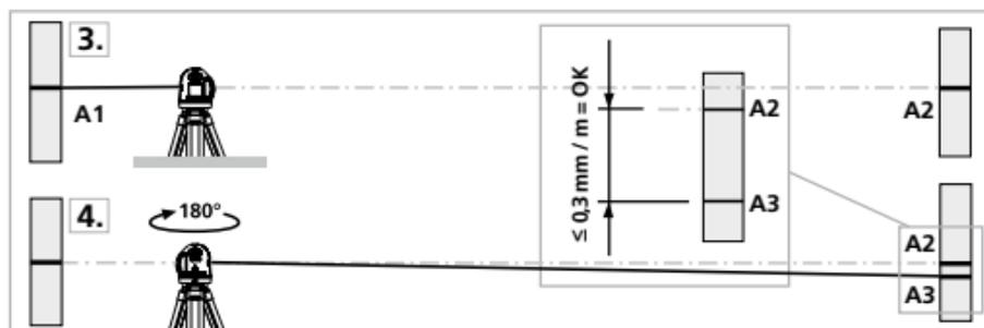
**!** Dacă A2 și A3 se află la o distanță mai mare de  $0,3 \text{ mm / m}$ , trebuie efectuată o ajustare. Contactați un comerciant specializat și adresați-vă departamentului service UMAREX-LASERLINER.
