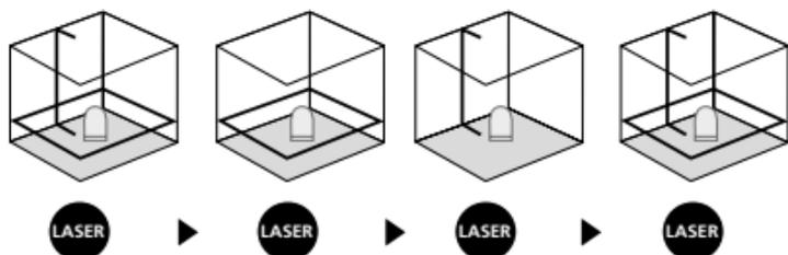
**!** Pentru nivelarea orizontală și verticală, siguranța pentru transport trebuie să fie îndepărtată. LED-ul luminează constant verde. De îndată ce aparatul se află în afara domeniului de nivelare automată de 4°, razele laser pâlpâie iar LED-ul luminează roșu. Poziționați aparatul astfel încât acesta să se afle în cadrul domeniului de nivelare. LED-ul se aprinde din nou verde iar razele laser luminează constant.
