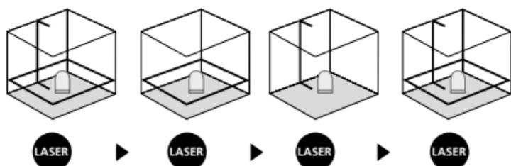
! Para poder efectuar la nivelación horizontal y vertical tiene que estar suelto el seguro de transporte. El LED está encendido con luz verde constante. Cuando el aparato se encuentra fuera del rango automático de nivelación de 4° las líneas láser parpadean y el LED se enciende con luz roja. Coloque el aparato en una posición dentro del rango de nivelación. El LED cambia de nuevo a luz verde y las líneas láser dejan de parpadear.
