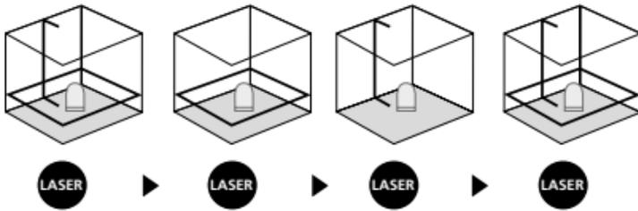
! Voor de horizontale en verticale nivellering moet de transportbeveiliging gedeactiveerd zijn. De led brandt constant groen. Zodra het apparaat zich buiten het automatische nivelleerbereik van 4° bevindt, knipperen de laserlijnen en brandt de led rood. Positioneer het apparaat zodanig dat het zich binnen het nivelleerbereik bevindt. De led schakelt weer over naar groen en de laserlijnen branden constant.
