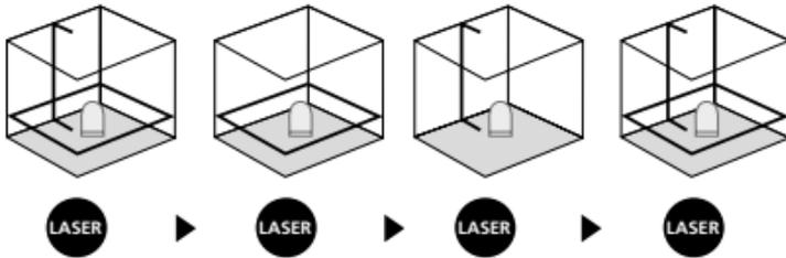
! Til horisontal og vertikal nivellering skal transportsikringen være løsnet. LED lyser konstant grøn. Så snart apparatet er uden for det automatiske nivelleringsområde på 4°, blinker laserlinjerne, og lysdioden (LED) løser rødt. Apparatet skal positioneres således, at det er inden for nivelleringsområdet. Lysdioden skifter igen til grønt, og laserlinjerne lyser konstant.
