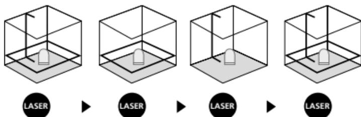
Transportni zatvarač se mora otpustiti za horizontalno i vertikalno niveliranje. Laserske linije bljeskaju i upali se crveni LED čim je uređaj izvan raspona automatskog niveliranja od 4°. Postaviti uređaj da bude unutar raspona nivelacije. LED se ponovno prebaci na zeleno, a laserske linije prestanu bljeskati (svijetli postojanim svjetlom).
