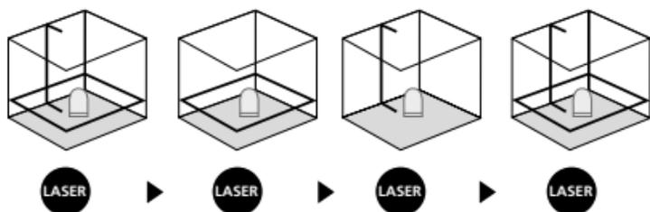
! Za vodoravno in navpično niveliranje je treba sprostiti transportno varovalo. Takoj, ko je naprava izven samodejnega območja niveliranja, ki znaša 4°, začnejo laserske linije utripati in LED-lučka zasveti rdeče. Napravo postavite tako, da ne bo znotraj območja niveliranja. LED-lučka bo znova preklopila na zeleno in laserske linije bodo stalno svetile.
