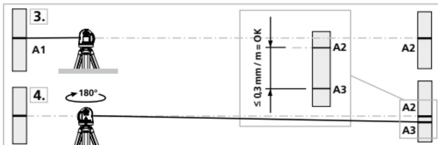
**!** Om A2 och A3 ligger mer än 0,3 mm / m från varandra behöver enheten justeras. Kontakta er återförsäljare eller vänd er till serviceavdelningen på UMAREX-LASERLINER.
