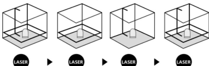
Il est nécessaire de dégager le blocage de transport pour procéder au nivellements horizontal et vertical. La DEL est allumée en permanence en vert. Dès que l'instrument se trouve en dehors de la plage de nivellement automatique de 4°, les lignes laser clignotent et la DEL s'allume en rouge. Positionner l'instrument de manière à ce qu'il soit dans la plage de nivellement. La DEL passe de nouveau au vert et les lignes laser sont allumées en permanence.
