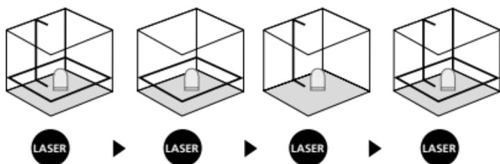
Для горизонтального и вертикального нивелирования необходимо снять с блокировки фиксатор для транспортировки. Постоянно горит зеленый светодиод. Как только прибор окажется за пределами автоматического диапазона нивелирования, равного 4°, лазерные линии и светодиод начинают гореть красным цветом. Позиционировать прибор так, чтобы он находился в пределах диапазона нивелирования. Светодиод снова изменяет свой цвет на зеленый, а лазерные линии светятся постоянно.
