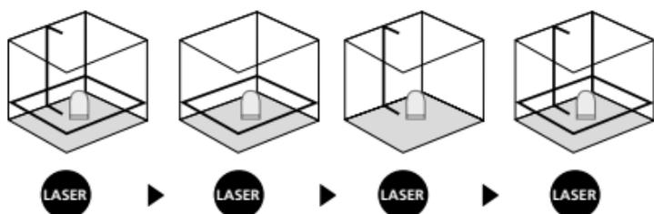
**!** Do niwelacji poziomej i pionowej zabezpieczenie transportowe musi być zwolnione. Dioda LED świeci stałym zielonym światłem. Gdy urządzenie znajduje się poza automatycznym zakresem niwelacji wynoszącym 4°, linie laserowe migają, a dioda LED świeci na czerwono. Ustawić urządzenie tak, aby znalazło się w zakresie niwelacji. Dioda LED ponownie świeci na zielono, a linie laserowe świecą stale.
