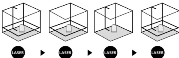
Na horizontálne a vertikálne nivelovanie musí byť prepravná poistka uvoľnená. Hneď ako sa prístroj nachádza mimo automatického nivelačného rozsahu 4°, laserové línie začnú blikať a LED sa rozsvieti načerveno. Polohu prístroja nastavte tak, aby sa nachádzal v rámci nivelačného rozsahu. LED sa zmení opäť nazeleno a laserové línie budú svietiť konštantne.
