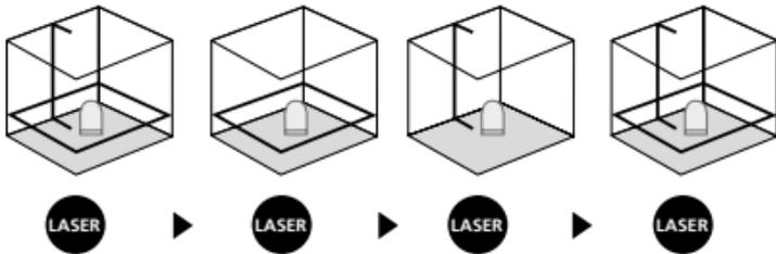
**!** Zum horizontalen und vertikalen Nivellieren muss die Transportsicherung gelöst sein. Sobald sich das Gerät außerhalb des automatischen Nivellierbereichs von 4° befindet, blinken die Laserlinien und die LED leuchtet rot auf. Positionieren Sie das Gerät so, das es sich innerhalb des Nivellierbereichs befindet. Die LED wechselt wieder auf grün und die Laserlinien leuchten konstant.
