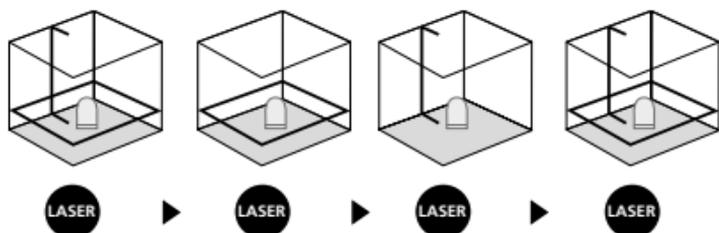
**!** Per il livellamento orizzontale e verticale si deve allentare la sicura di trasporto. Il LED rimane acceso in verde. Non appena l'apparecchio si venisse a trovare al di fuori del campo di livellamento automatico di 4°, le linee laser iniziano a lampeggiare e si accende la luce rossa del LED. Posizionare l'apparecchio in modo che si trovi all'interno del campo di livellamento. La luce del LED diventa verde e le linee laser emettono una luce costante.
