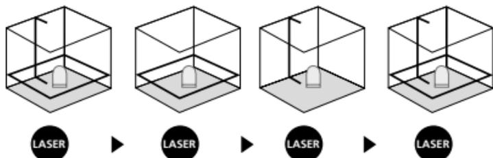
! За хоризонтално и вертикално нивелиране трябва да се освободи транспортното обезопасяване. LED свети постоянно в зелено. Щом уредът се намира извън зоната на автоматично нивелиране 4°, лазерните линии мигат и LED светва в червено. Позиционирайте уреда така, че да се намира вътре в зоната на нивелиране. LED отново превключва на зелено и лазерните линии светят постоянно.
