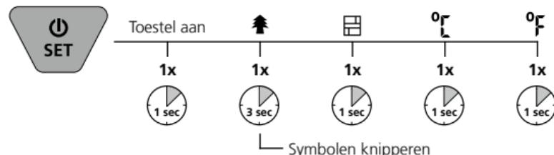
! Het apparaat start met de als laatste ingestelde meetmodus. Druk 3 seconden lang op de Set-toets om de modus in te stellen of wacht even totdat het symbool niet meer knippert.
