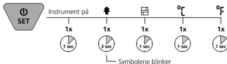
! Instrumentet starter med den målemodus som sist var valgt. Til valg av modus trykkes Set-knappen i 3 sekunder, eller vent til symbolen ikke blinker mer.
