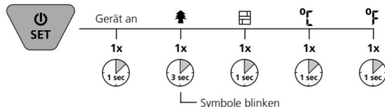
! Das Gerät startet mit dem zuletzt gewählten Messmodus. Zur Auswahl des Modus die Set-Taste 3 Sekunden drücken oder kurz warten, bis das Symbol nicht mehr blinkt.
