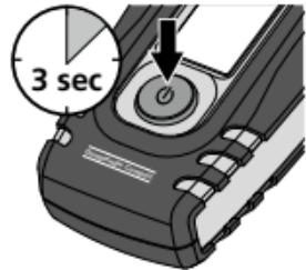
Etter at apparatet er slått på, vises omgivelsestemperaturen i displayet i 3 sekunder.
