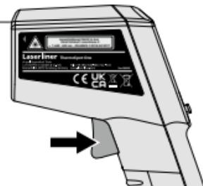
Отпустить кнопку, как только направленный луч лазера попадет на нужный участок измерений. Результат измерения удерживается на экране.
