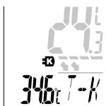
Přístroj se automaticky přepne do režimu kontaktní teploty T-K hned po připojení teplotního čidla (typ K). Dokud je teplotní čidlo připojené, přístroj se automaticky nevypne v případě, že je nabité baterie alespoň 15%.
