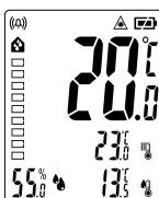
Différence entre la température ambiante/de surface : <3,5 °C aucun pont thermique
