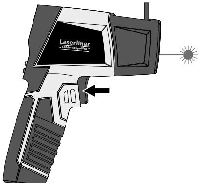
Relâcher la touche dès que le laser de visée détecte le point de mesure souhaité. La valeur mesurée est conservée (Hold).
