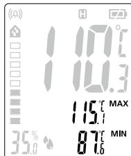
Modus Max/Min refererer til infrarød-temperaturen og viser maksimal og minimal infrarød-temperatur. Max/Min-værdierne beregnes ved nedtrykt udløser (8) under den aktuelle måling. Ved start af en ny måling eller ved at trykke udløseren (8) ned, slettes værdien og beregnes på ny.
