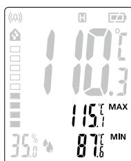
De modus Max/Min heeft betrekking op de infrarood-temperatuur en geeft de maximale en de minimale infrarood-temperatuur aan. De Max/Min-waarden worden tijdens de lopende meting bij ingedrukte activeringstoets (8) bepaald. Bij de start van een nieuwe meting resp. door indrukken van de activeringstoets (8) wordt de waarde gewist en opnieuw berekend.
