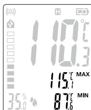
El modo de máxima y mínima hace referencia a la temperatura por infrarrojos e indica la temperatura máxima y mínima respectivamente. Los valores de máxima y mínima se calculan durante la medición manteniendo pulsado el botón de activación (8). Al inicio de una nueva medición, o al pulsar la activación (8), se borra el valor y se calcula de nuevo.
