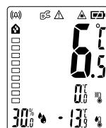
Différence entre la température ambiante/de surface : ≥-6,5 °C pont thermique, l'écran s'allume en rouge et le symbole « » clignote
