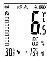
Differenz Umgebungstemp./Oberflächentemp.:  $\geq -6,5^{\circ}\text{C}$
