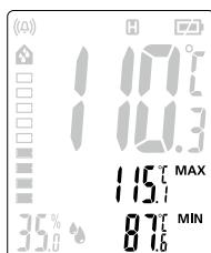
Le mode Max./Min. se base sur la température infrarouge et affiche la température par infrarouge maximale/minimale. Les valeurs Max./Min. sont calculées pendant la mesure en cours lorsque l'on appuie sur la touche de déclenchement (8). La valeur est supprimée et à nouveau calculée lorsqu'une nouvelle mesure est lancée ou en appuyant sur la touche de déclenchement (8).
