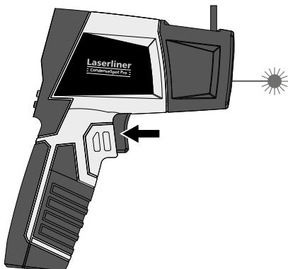
Non appena il punto da misurare è stato rilevato con il laser di puntamento, rilasciare il tasto. Il valore misurato rimane visualizzato (Hold).
