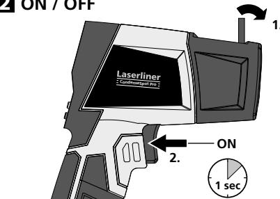
Il est, en plus, possible de mettre l'instrument en marche en appuyant sur la touche d'alarme (3). Cela ne déclenche pas de mesure et les dernières valeurs mesurées s'affichent.
