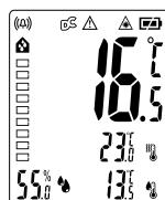
Différence entre la température ambiante/de surface : ≥6,5 °C pont thermique, l'écran s'allume en bleu et le symbole « » clignote
