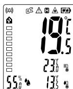
Différence entre la température ambiante/de surface : ≥3,5 °C éventuellement un pont thermique, le symbole « » clignote, continuer de contrôler la zone
