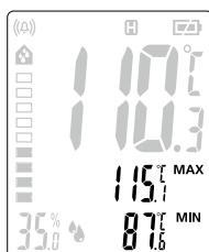
La modalità Max/Min si riferisce alla temperatura a infrarossi e indica la temperatura massima e minima della radiazione infrarossa. I valori Max/Min vengono rilevati durante la misurazione in corso con il tasto di avvio premuto (8). Quando si avvia una nuova misurazione o premendo il tasto di avvio (8) il valore viene cancellato e calcolato di nuovo.
