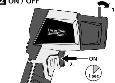
Het toestel kan bovendien worden ingeschakeld via de toets alarmfunctie (3). Daardoor wordt geen meting geactiveerd, maar worden de laatste meetwaarden weergegeven.
