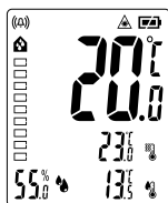
Ympäristö-/pintalämpötilan ero: < 3,5 °C ei kylmäsiltaa
