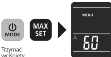
Jednoczesne wciśnięcie i przytrzymanie przycisków ON/OFF i MAX powoduje przejście do menu. W tym miejscu można ustawić próg suchości, alarm i funkcje automatycznego wyłączania.
