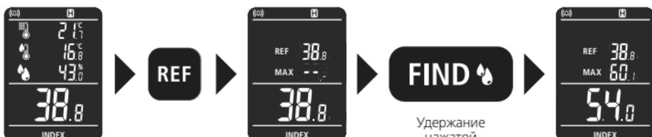
Вы можете использовать функцию контрольного значения, чтобы получить представление о распределении влаги в стене. Найдите сухое место на измеряемом материале и определите содержание влаги, как описано в главе 6 «Процесс измерения». Нажатием кнопки «REF» сохраните измеренное значение в качестве контрольного значения. Измерьте влажность в другом месте. Вы сможете сравнить контрольное, максимальное и текущее измеренное значение.
