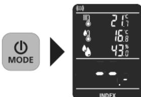
**Index-läget** är avsett för snabb identifiering av fukt genom jämförande mätningar, **utan** att direkt ange fukthalten i materialet i %. Det visade värdet (0 – 199,9) är ett indicerat värde som ökar med tilltagande fuktighet i materialet. De mätningar, som görs i Index-läget, är oberoende av materialet
