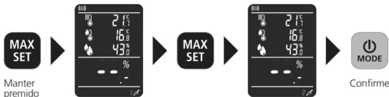
Há 3 grupos de material: Chapa de cimento, betonilha de anidrite e betão em Massa-% e CM-%. Após um reinício é mantido o material por último utilizado.
