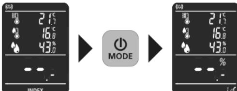
Apparaten har 2 lägen för fuktmätning beroende på material. Genom att trycka på knappen "MODE" växlar man mellan det centrala, materialberoende INDEX-läget och det extra byggnadsmaterial-läget.
