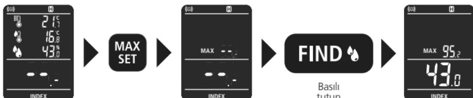
Cihaz MAX değeri sadece bir ölçüm işlemi dahilinde muhafaza edebilir. Ölçüm işleminden sonra MAX değer gösterilmektedir. "FIND" tuşu basılı tutularak tekrar ölçüm durumunda MAX değer ve güncel değer gösterilmektedir.
