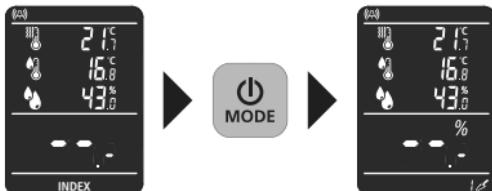
Laitteessa on 2 käyttötilaa kosteuden mittaamista varten, materiaalista riippuen. MODE-painiketta painamalla voit vaihtaa keskeisen, materiaaleista riippumattoman INDEX-tilan ja rakennusmateriaalitilan välillä.
