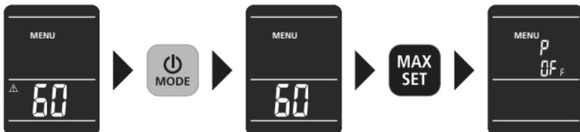
Enheten har en automatisk avstängning. Den kan ske efter 3 minuter eller 60 minuter. För att använda enheten som hygrometer för övervakning av inomhusklimatet bör automatisk avstängning efter 60 minuter vara inställd.
