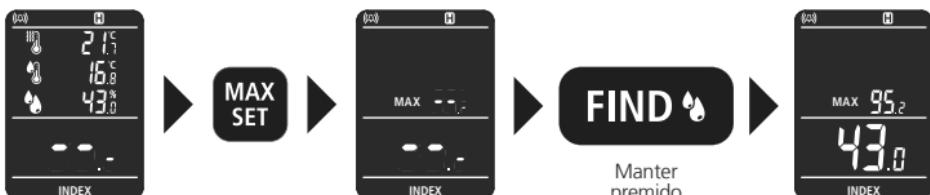
O aparelho só pode manter o valor MAX dentro de um processo de medição. Após o processo de medição é indicado o valor MAX. Ao medir novamente mantendo premido o botão "FIND", o valor MAX e o valor atual são indicados.
