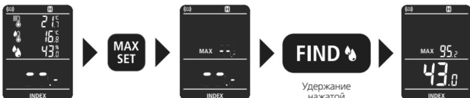
Прибор может сохранять максимальное значение только в течение одного процесса измерения. По окончании процесса измерения отображается максимальное значение. При повторном измерении (нажать и удерживать кнопку «FIND») отображается максимальное и текущее значение.
