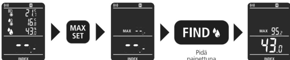
Laite voi säilyttää MAX-arvon vain yhden mittausprosessin ajan. MAX-arvo näytetään mittauksen jälkeen. Kun mittaat uudelleen pitämällä FIND-painikkeen painettuna, näytetään MAX-arvo ja nykyinen arvo.
