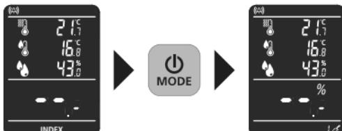
Urządzenie posiada 2 tryby pomiaru wilgotności w zależności od materiału. Naciśnięcie przycisku „MODE” powoduje przełączenie między głównym, niezależnym od materiału trybem INDEX a trybem dodatkowych materiałów budowlanych.
