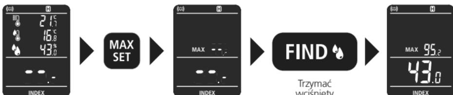
Urządzenie może zachować wartość MAX tylko w ramach jednej procedury pomiaru. Po wykonaniu pomiaru wyświetlana jest wartość MAX. Podczas ponownego pomiaru z przytrzymaniem przycisku „FIND” wyświetlana jest wartość MAX i wartość bieżąca.
