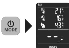
O modo índice tem por finalidade a deteção rápida de humidade através de medições comparativas, sem a indicação direta da humidade no material em %. O valor indicado (0 a 199,9) é um valor indexado que aumenta com uma humidade crescente no material. As medições que são efetuadas no modo índice
