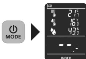
**Tryb indeksowy** służy do szybkiego wyszukiwania wilgotci poprzez pomiary porównawcze, **bez** bezpośredniego wskazania wilgotności materiału w procentach. Podana wartość (0 do 199,9) to wartość indeksowa rosnąca wraz ze wzrostem wilgotności materiału. Pomiary dokonywane w trybie indeksowym są niezależne od materiałów i nadają się do materiałów, dla których nie ma wczytanych charakterystyk. Przy dużych odchyłach wartości przy pomiarach porównawczych łatwo jest zlokalizować wilgoć.
