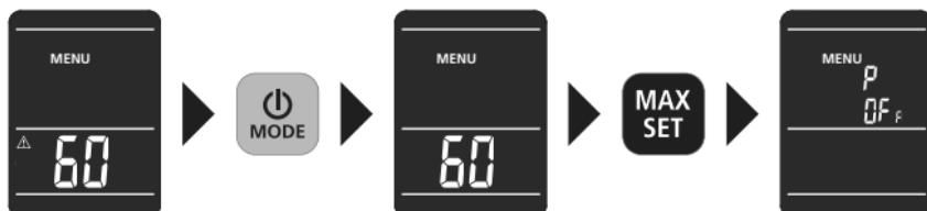
Urządzenie wyposażone jest w funkcję automatycznego wyłączania. Może ono nastąpić po upływie 3 lub 60 minut. W przypadku wykorzystania urządzenia jako higrometru do monitorowania klimatu pomieszczenia warto ustawić urządzenie tak, aby wyłączało się automatycznie po upływie 60 minut.
