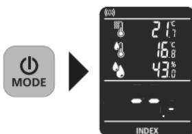
**Indeksmodus** tjener til rask oppsporing av fuktighet gjennom sammenligningsmålinger, **uten** noen direkte visning av materialfuktigheten i %. Den viste verdien (0 til 199,9) er en indikert verdi, som stiger etter hvert som materialfuktigheten blir større. Målingene som foretas i indeksmodus er
