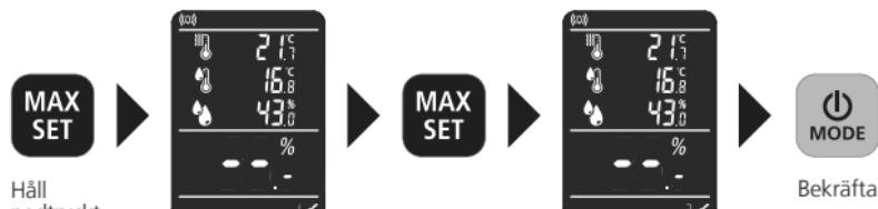
Det finns 3 materialgrupper: cementavjämning, anhydritavjämning och betong i mass-% och CM-%. Efter omstart bibehålls det senast använda materialet.
