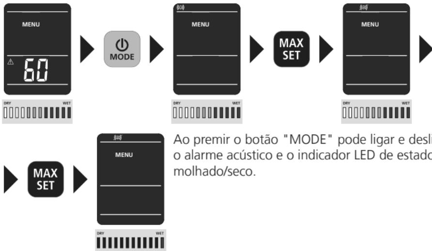
Ao premir o botão "MODE" pode ligar e desligar o alarme acústico e o indicador LED de estado molhado/seco.
