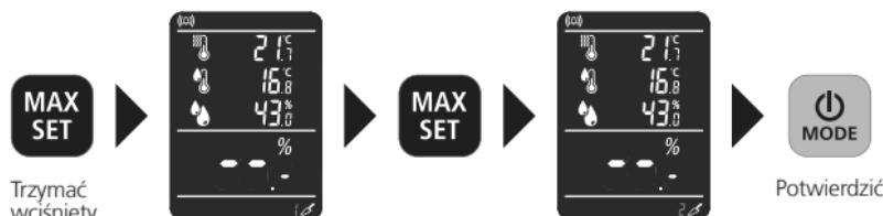
Istnieją 3 grupy materiałów: Jastrzyc cementowy, anhydrytowy i beton, każdy w postaci masy % i CM%. Po ponownym uruchomieniu zachowany zostaje ostatnio użyty materiał.
