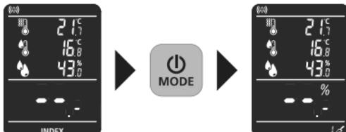
Apparatet har 2 moduser for fuktighetsmåling, avhengig av det aktuelle materialet. Ved å trykke på «MODE» knappen skifter man mellom den sentrale, materialuavhengige INDEX-modus og den ekstra byggematerial-modus.
