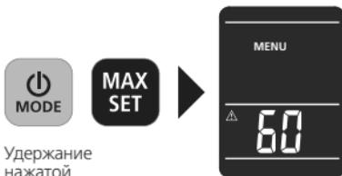
Чтобы войти в меню, нажмите и удерживайте кнопки ON/OFF и MAX одновременно. Здесь вы можете настроить пороговое значение сухости, функцию предупредительного сигнала и автоматического отключения.
