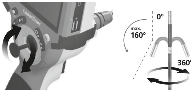
I ny tilstand fra fabrikken er maksimal vinkelposisjon for 3D-kamerahodet  $160^\circ$ , med en toleranse på  $\pm 5^\circ$ . For dette må kamerasonden være i helt rett posisjon, dvs. uten unødvendige kurver eller bøyninger. Normal mekanisk slitasje kan føre til at den maksimale vinkelposisjonen reduseres i løpet av produktets levetid.
