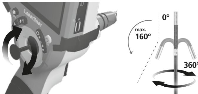
La position angulaire maximale de la tête de la caméra 3D est, départ usine, à l'état neuf, 160° avec une tolérance de  $\pm 5^\circ$ . La sonde de la caméra doit, pour cela, être entièrement droite, donc sans courbes ni flexions inutiles. L'usure mécanique normale peut réduire la position angulaire maximale tout au long de la vie du produit.
