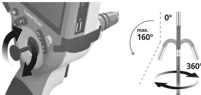
Η μέγιστη ρύθμιση γωνίας της κεφαλής κάμερας 3D είναι σε καινούργια κατάσταση εργοστασιακά 160° με ανοχή ± 5°. Για αυτό, ο αισθητήρας κάμερας πρέπει να βρίσκεται σε εντελώς ίσια θέση, δηλαδή χωρίς μη αναγκαίες καμπύλες ή λυγίσματα. Λόγω φυσιολογικής μηχανικής φθοράς, η μέγιστη ρύθμιση γωνίας μπορεί να μειωθεί στη διάρκεια ζωής του προϊόντος.
