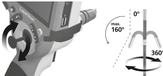
Maximální úhlová poloha 3D hlavy kamery v novém stavu je  $160^\circ$  s tolerancí  $\pm 5^\circ$ . Přitom musí být sonda kamery ve zcela rovné poloze, tedy bez zbytečných nerovností nebo ohybů. Běžné mechanické opotřebování může během životnosti vyrobku snížit maximální úhlovou polohu.
