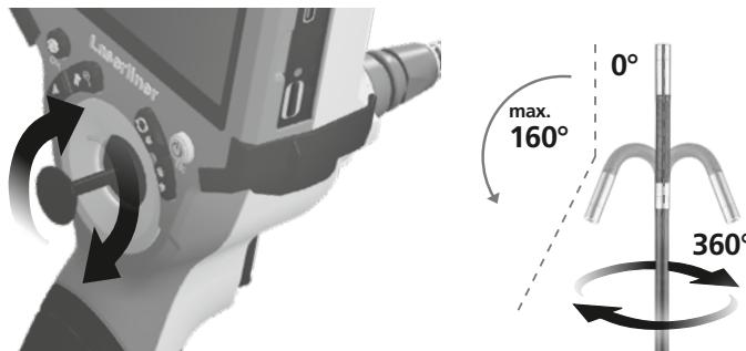
Die maximale Winkelstellung des 3D-Kamerakopfes beträgt im Neuzustand werksseitig  $160^\circ$ , mit einer Toleranz von  $\pm 5^\circ$ . Dazu muss sich die Kamerasonde in völlig gerader Lage befinden, also ohne unnötige Kurven oder Biegungen. Durch normalen mechanischen Verschleiß kann sich die maximale Winkelstellung im Laufe der Lebensdauer des Produkts verringern.
