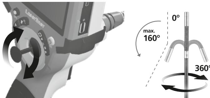
Максимальное угловое отклонение головки 3D-камеры в новом заводском состоянии составляет  $160^\circ$  с допуском  $\pm 5^\circ$ . Для этого зонд камеры должен находиться в абсолютно прямом положении, т.е. без излишних изгибов и поворотов. Из-за нормального механического износа максимальное угловое отклонение может уменьшаться в течение срока службы изделия.
