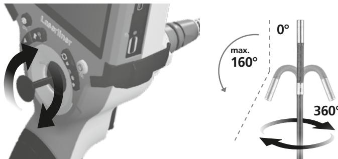
La posizione angolare massima della testina di ripresa 3D è di 160° quando nuova di fabbrica, con una tolleranza di  $\pm 5^\circ$ . A tale scopo la sonda con telecamera deve trovarsi in una posizione completamente rettilinea, quindi senza curve o incurvamenti inutili. Una normale usura meccanica può ridurre la posizione angolare massima nel corso della durata di vita del prodotto.
