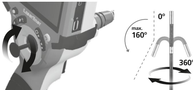
Uuden 3D-kamerapään maksimikulma-asento on tehdasasetuksena  $160^\circ$  toleranssilla  $\pm 5^\circ$ . Sitä varten kamerasondin tulee olla täysin suorassa asennossa, siis ilman tarpeettomia mutkia. Normaalilin mekaanisen kulumisen vuoksi maksimikulma-asento saattaa pienentyä tuotteen käyttöön aikana.
