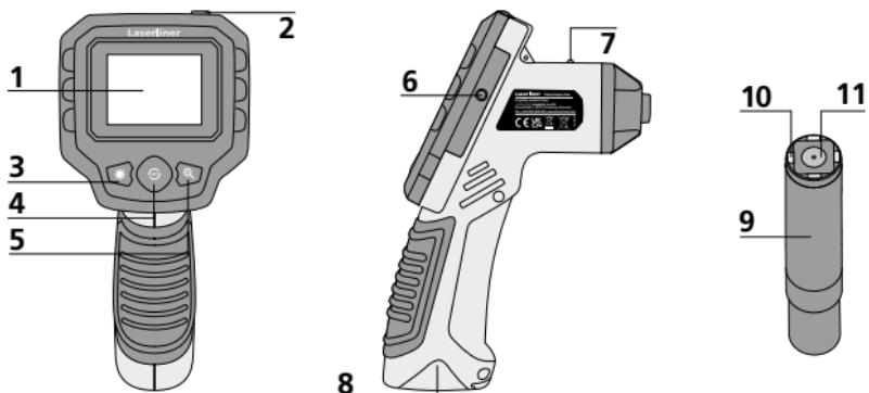
**1 LCD displej****5 Zoom****8 Přihrádka pro baterie****2 ON/OFF****6 Připojka externího monitoru****9 Hlava kamery****3 Osvětlení LED****7 Provozní ukazatele****10 LED**
