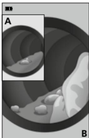
4. Seçilen referans resim (A) ekrana yansır, arka planda ise karşılaştırma yapılabilmesi için canlı görünüm (B) gösterilir.
