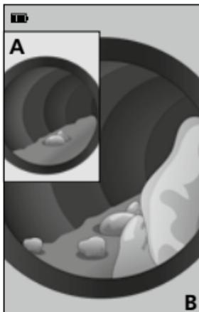
4. Выбранное эталонное изображение (A) появляется на дисплее, на заднем плане отображается фото реального состояния (B) для сравнения
