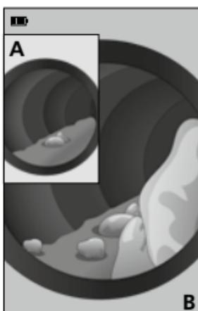
4. Na displeji se objeví vybraný referenční obrázek (A) na pozadí běží pro srovnání live náhled (B).
