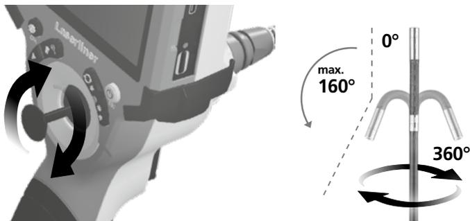
Максимальне кутове положення нової голівки 3D-камери, задане заводом-виробником, становить  $160^\circ$  з допуском  $\pm 5^\circ$ . Для цього зонд камери повинен знаходитися в абсолютно прямому положенні, тобто без непотрібних вигинів або поворотів. Внаслідок нормального механічного зносу максимальне кутове положення протягом усього терміну служби виробу може поступово зменшуватися.
