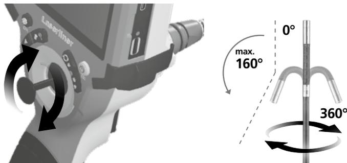
Den maksimale vinkelposition for 3D-kamerahovedet i ny tilstand er fra fabrikken indstillet til 160° med en tolerance på  $\pm 5^\circ$ . For at opnå dette skal kamerasonden være i en helt lige position, det vil sige uden unødvendige kurver eller bøjninger. På grund af normal mekanisk slitage kan den maksimale vinkelposition blive forringet i løbet af produktets levetid.
