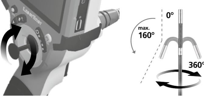
Yeni olduğunda 3D kamera kafasının maksimum açısal konumu fabrikada  $\pm 5^\circ$  toleransla  $160^\circ$ 'dir. Bunun için kamera sondası tamamen düz bir konumda olmalıdır, yani gereksiz kıvrımlar veya bükülmeler olmamalıdır. Normal mekanik aşınma ve yıpranma, ürünün kullanım ömrü boyunca maksimum açısal konumu azaltabilir.
