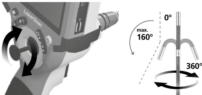
カメラヘッドの工場出荷時の最大可動角度は160°(許容誤差±5°)です。最大角度で可動させるためにはカメラケーブルが完全な直線(曲線やカーブがない)状態にする必要があります。最大可動角度は製品寿命や通常使用による機械的な摩耗・損傷により減少する可能性があります。
