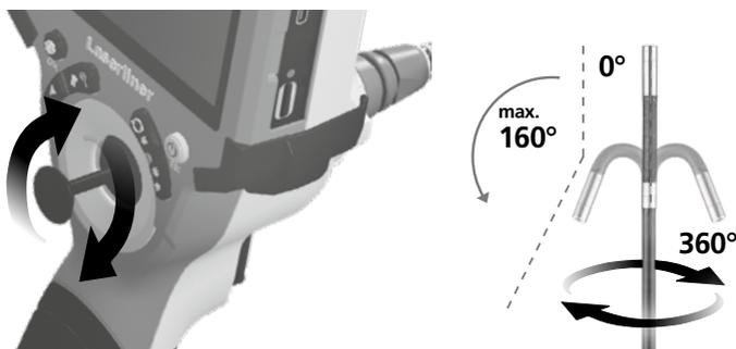
Poziția unghiulară maximă a capului camerei 3D, atunci când este nou, este de 160° din fabrică, cu o toleranță de  $\pm 5^\circ$ . Pentru aceasta, sonda camerei trebuie să se afle într-o poziție complet dreaptă, adică fără curburi sau îndoituri inutile. Uzura mecanică normală poate reduce poziția unghiulară maximă pe parcursul duratei de viață a produsului.
