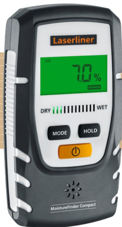
Analizzatore di umidità dei materiali per la misurazione non distruttiva del legno e dei materiali da costruzione - Utilizzo di materiale riciclato per la sostenibilità
