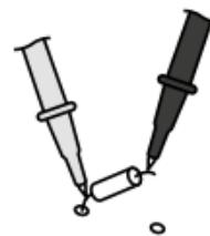
Pokud by se na displeji nezobrazila naměřená hodnota, ale „1“, je buďto překročený měřený rozsah nebo není uzavřený resp. je přerušený měřený obvod.
