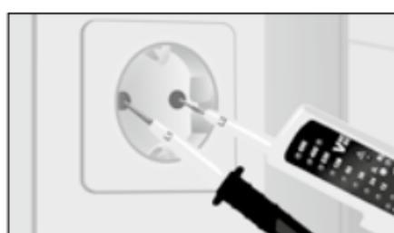
Tome el aparato básico (+) en la mano derecha y la segunda punta de comprobación (-) en la mano izquierda. Aplique las puntas de medición en los contactos a comprobar (p. ej. cables, enchufes, etc.).
