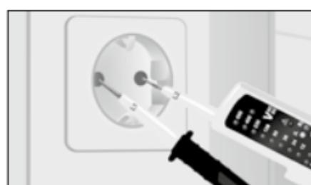
Nehmen Sie das Basisgerät (+) in die rechte Hand und die zweite Prüfspitze (-) in die linke Hand. Führen Sie nun die Meßspitzen an die zu prüfenden Kontakte (z.B. Leitung, Steckdose, etc.).
