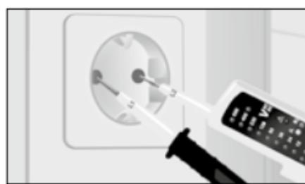
Візьміть основну частину приладу (+) у праву руку, а другий випробувальний щуп (-) – у ліву. Піднесіть вимірювальні щупи до контактів, що перевіряються (наприклад, електропроводки, розетки тощо).
