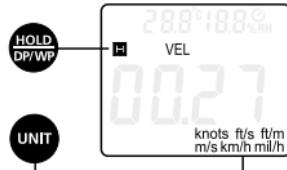
Trykk på tasten MAX/MIN for å vise den høyeste/laveste målte verdien i displayet. Med tasten HOLD kan du holde fast den aktuelle måleverdien.
