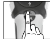
**AC-SCAN:** Lokaliseren van spanningvoerende kabels direct onder niet-metalen bekistingen
