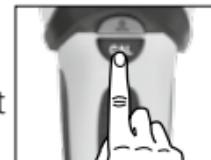
Pour atteindre la sensibilité maximale de l'instrument, maintenir l'instrument en l'air lors du calibrage. Cela peut être par endroit judicieux pour les mesures METAL et AC-SCAN.
