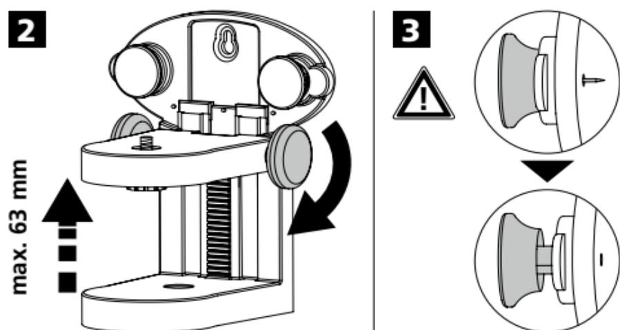
**!** Risque de pincement ! Ne pas mettre les doigts dans la pince de serrage !
