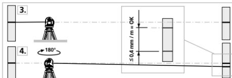
3. Stellen Sie das Gerät so nah wie möglich an die Wand auf Höhe des markierten Punktes A1.
