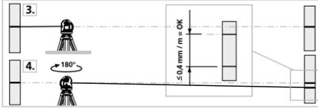
3. Cihazı olabildiğince duvara yaklaştırıp A1 noktasının hizasına kurunuz.
