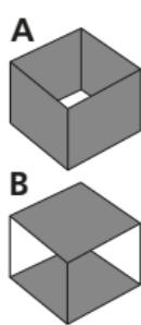
Die Libellen sind nur zu den vier Auflageflächen A (siehe Abbildung) justiert. Bei Auflage auf die Flächen B kann das Gerät nicht als Wasserwaage verwendet werden.
