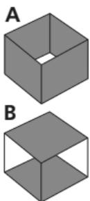
Уровни настроены только по четырем опорным поверхностям А (см. рисунок). При размещении на поверхностях В использовать прибор в качестве уровня нельзя.
