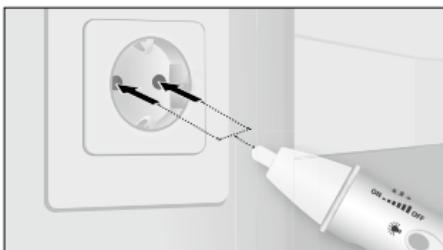
Aplique la punta del detector sobre las zonas a comprobar (p. ej. cables, enchufes, etc.).
