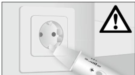
Hvis der findes spænding, lyser detektorspidsen, og der lyder et signal.
