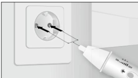
Sæt detektorspidsen på det område, der skal prøves (fx kabel, stikkontakt, osv.).
