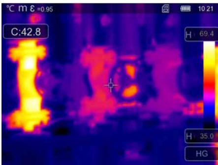
**H** In der Histogramm-Einstellung wird die Farbverteilung des Infrarotbildes ähnlich wie in der automatischen Einstellung angepasst. Zusätzlich wird durch eine statistische Bewertung der Temperaturverteilung im Infrarotbild (Histogramm) eine Stabilisierung der Min./Max.-Werte erreicht. Dadurch findet bei stark schwankenden Temperaturverhältnissen eine Stabilisierung der Ansicht von Bild zu Bild statt (z.B. bei Messungen an bewegten Objekten).
