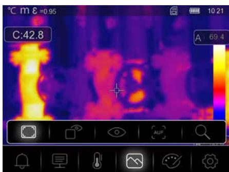
Es gibt fünf verschiedene Bildmodi für die Anzeige: IR Thermisch, MIX Image, Sichtbares Bild, Auto Fusion, Zoom
