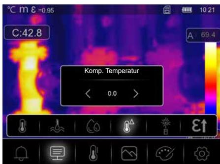
Die Kompensation der Temperatur kann zwischen  $-5,0\text{ °C}$  und  $5,0\text{ °C}$  eingestellt werden.
