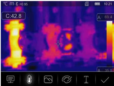
Durch Drücken des Auslösers wird das Bild eingefroren und das Speichermenü erscheint. Im Speichermenü kann die Aufnahme vor dem Speichern bearbeitet werden. Es besteht die Möglichkeit, schriftliche Kommentare hinzuzufügen. Durch Drücken des Textnotiz-Symbols öffnet sich ein Editor mit Tastatur. Mit dem Haken-Symbol wird der Editor nach der Texteingabe beendet.
