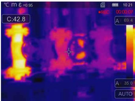
Die Videoaufnahme startet durch mindestens 2-sekündiges Drücken des Auslösers. Das Beenden und Speichern der Aufnahme erfolgt mit erneutem Drücken des Auslösers.
