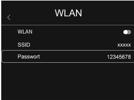
Über WLAN kann eine Verbindung mit dem Gerät hergestellt werden. Die Standard -SSID ist „**TCHS**“ bzw. „**TCHS Pro**“ und das Standard-Passwort ist „**12345678**“. Nach der Verbindung mit der Laserliner HighSense App kann auf die Kameradaten zugegriffen werden.
