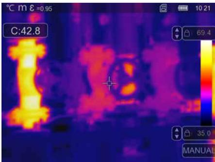
**🔒** In der manuellen Einstellung wird der Temperaturbereich nicht mehr durch die gemessenen Min./Max.-Werte automatisch eingestellt, sondern durch manuelle Werte festgelegt.
