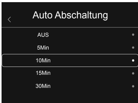
Das Gerät schaltet sich nach dem eingestellten Zeitraum der Inaktivität automatisch ab. Der Timer wird beendet, wenn der Touchscreen berührt oder eine Taste gedrückt wird.
