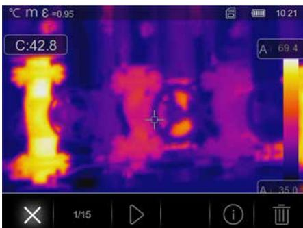
In der Mediengalerie können alle mit der Wärmebildkamera aufgenommenen Bild- und Videodaten aufgerufen, abgespielt und verwaltet werden. Die Mediengalerie kann über die linke Direkttaste aufgerufen werden.
