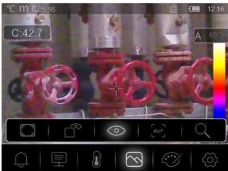
Im **Sichtbares Bild**-Modus wird das Digitalbild angezeigt.
