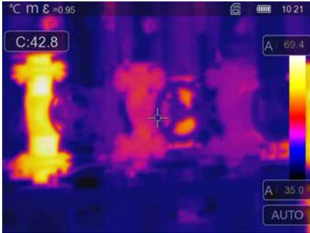
**A** In der automatischen Einstellung wird der gemessene Temperaturbereich des Infrarotbildes und die daraus resultierende Verteilung des Farbspektrums permanent eingestellt. Das Farbspektrum des gemessenen Infrarotbildes wird in Relation zum Temperaturbereich und zur Farbskala ermittelt. Die Farbverteilung des Infrarotbildes wird anhand der gemessenen Min./Max.-Werte automatisch und dynamisch im Bargraph angepasst.
