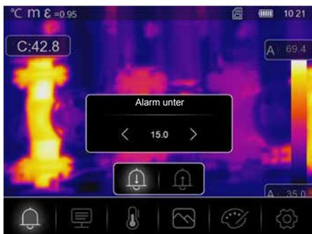
Die Grenzwerte für den Alarm oberhalb und unterhalb des spezifizierten Temperaturniveaus können in diesem Menü festgelegt werden. Das anschließende Aktivieren des Alarms ist in Kapitel 14.3 beschrieben.
