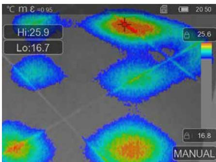
**Fußbodenheizungs-Kontrolle** dient dem Sichtbarmachen des Leitungsverlaufes, Wärmeverteilungen sowie möglichen Luft einschlüssen. Sie können sich vergewissern, ob eine vorhandene oder neu installierte Fußbodenheizung gleichmäßig erwärmt ist. Die Wärmebildkamera gibt Auskunft über die Oberflächentemperatur des Fußbodens, was ebenfalls ein wichtiger Indikator für die Effizienz des Heizsystems ist.
