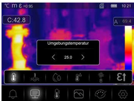
Die Umgebungstemperatur beeinflusst die Messung der Wärmebildkamera. Durch diesen Parameter kann der Einfluss der Umgebungstemperatur auf die Messung kompensiert werden. Eingestellt werden kann diese zwischen 0 °C und 50 °C.
