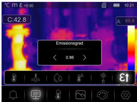
Der Grad der Infrarotabstrahlung, die jeder Körper material-/oberflächenspezifisch abgibt, wird durch den Emissionsgrad bestimmt ( $0,01 \dots 1,0$ ). Zu einer korrekten Messung ist es zwingend erforderlich den Emissionsgrad einzustellen. Neben den vorgegebenen Emissionsgraden aus der Materialliste ist das Einstellen eines individuellen Emissionsgrades möglich.
