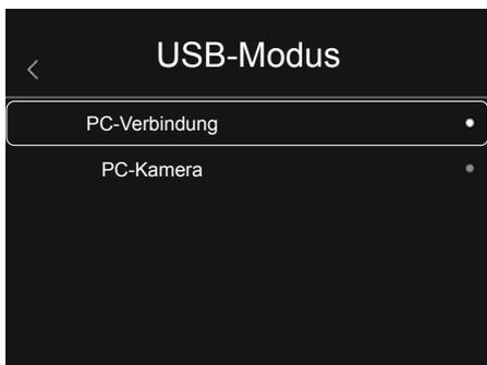
Im USB-Modus können die erfassten Daten von der Wärmebildkamera an einen PC übermittelt werden. Um das Betrachten des Kamerabildes mehreren Personen gleichzeitig zu ermöglichen, kann der PC zur Live-Übertragung genutzt werden. Das USB-Laufwerk muss, nach der Nutzung am PC, korrekt ausgeworfen werden, um Lesefehler am PC zu vermeiden.
