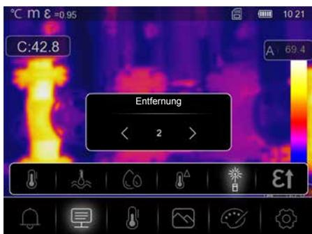
In der Luft befinden sich zahlreiche Stoffe, welche die Infrarotstrahlen absorbieren können. Dadurch verringert sich die Infrarotstrahlung des untersuchten Objekts mit zunehmender Entfernung. Ab einer Entfernung von 10 Metern sind die atmosphärischen Einflüsse der Luft auf jeden Fall zu berücksichtigen. Die Entfernung ist zwischen 0 und 2.000 Metern einstellbar.
