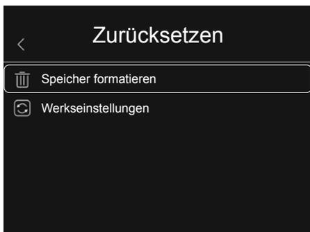
Die aktuelle Mediengalerie kann mit der Auswahl „**Speicher formatieren**“ gelöscht werden. Alle vorgenommenen Einstellungen können mit der Auswahl „**Werkseinstellungen**“ gelöscht werden. Es wird empfohlen die SD-Karte direkt am PC im Format FAT32 zu formatieren
