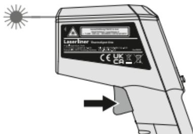
Natychmiast po osiągnięciu przez celownik laserowy żądanej miejsca pomiaru zwolnić przycisk. Zmierzona wartość zostanie zapamiętana.
