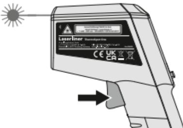
Så snart det ønskede målested detekteres med mållaseren, slipper man knappen. Den målte værdi fastholdes.
