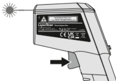
Logo que o local de medição pretendido seja detetado pelo laser alvo, solte a tecla. O valor medido é mantido.
