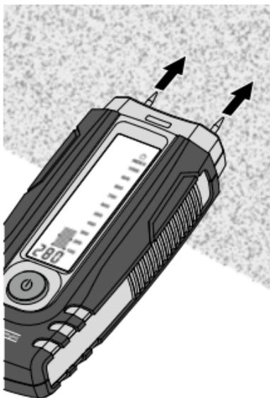
Πρέπει να προσέχετε ότι σε τοίχους (επιφάνειες) διαφορετικής σύνθεσης υλικού κατασκευής, ή ακόμη και η διαφορετική σύνθεση δομικών υλικών, μπορεί να έχουν ως αποτέλεσμα την αλλοίωση των αποτελεσμάτων μέτρησης. **Εκτελείτε αρκετές συγκριτικές μετρήσεις.**
