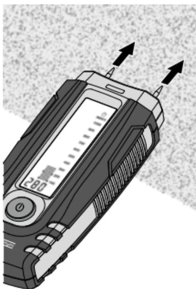
Figyelembe kell venni, hogy különféle anyagrétegekkel rendelkező falaknál (felületeknél), illetve az építőanyagok különféle összetétele is meghamisíthatja a mérési eredményeket. **Végezzen több összehasonlító mérést.**
