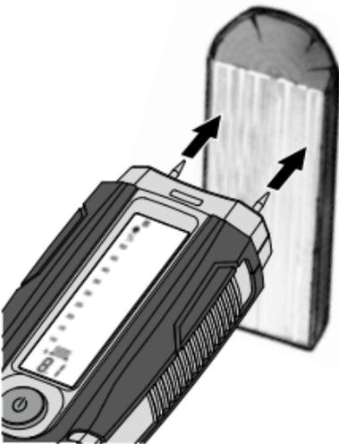
Locul de măsurat trebuie să fi e netratat și liber de noduri, murdărie sau rășină. Nu e voie efectuarea măsurării la capete pentru că lemnul se usucă deosebit de repede la aceste locuri și astfel pot rezulta erori la măsurare. **Executați mai multe măsurări de comparare transversal față de fibră.**
