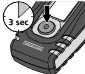
След включване на прибора на дисплея в продължение на 3 секунди се появява температурата на обкръжението.
