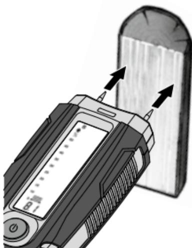
A mérendő helynek kezeletlennek, és ágaktól, kosztól vagy gyantától mentesnek kell lennie. Ne végezzen méréseket a homloklfelületeken, mivel a fa itt különösen gyorsan szárad, és így a mérés hamis eredményt adhat. **Végezzen több összehasonlító mérést az erezetre merőlegesen.**
