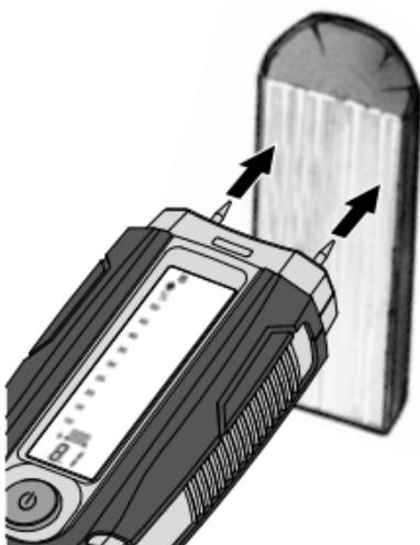
Mjesto gdje se obavlja mjerenje treba biti neobrađeno, bez kvrga, nečistoća i smole. Mjerenja se ne bi trebala obavljati na krajnjim rubovima drva jer se ta područja najbrže suše pa se dobiju netočni rezultati mjerenja. **Obaviti nekoliko usporednih mjerenja duž šara u drvu.**
