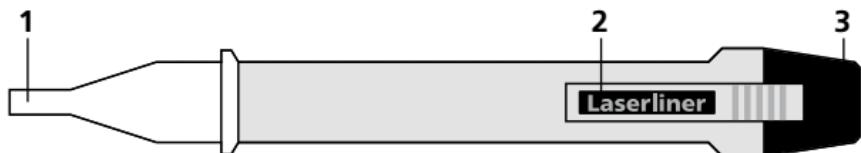
1 Punta del rilevatore    2 Clip per tasca    3 Vano batterie
