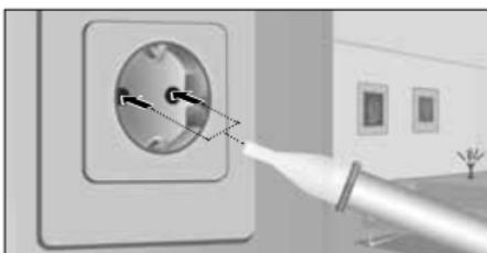
Proszę przyłożyć wierzchołek detektora do badanego obszaru (np. kabel, gniazdo elektryczne, itp.)
