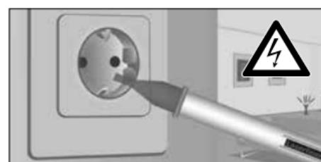
Hvis der findes en spænding, lyser detektorspidsen.
