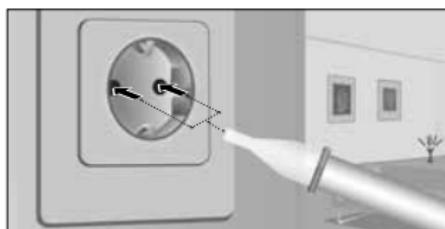
Coloque a ponta do detetor sobre a área a controlar (p. ex. cabo, tomada, etc.).
