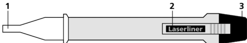
1 Punta del detector    2 Clip de bolsillo    3 Compartimento de pilas
