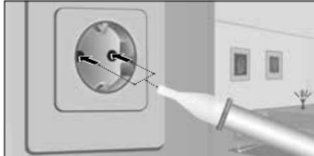
Plaats de detectorpunt op het te controleren bereik (bijv. kabel, contactdoos, enz.).
