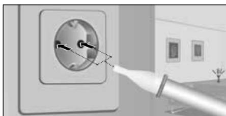
Aplique la punta del detector sobre las zonas a comprobar (p. ej. cables, enchufes, etc.).
