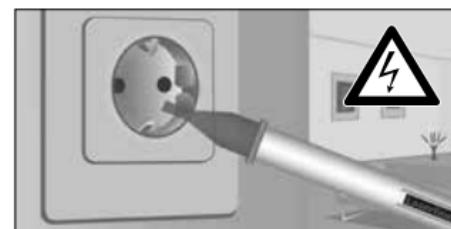
Se for detetada tensão, a ponta do detetor acende.
