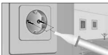
Sæt detektorspidsen på det område, der skal prøves (fx kabel, stikkontakt, osv.).
