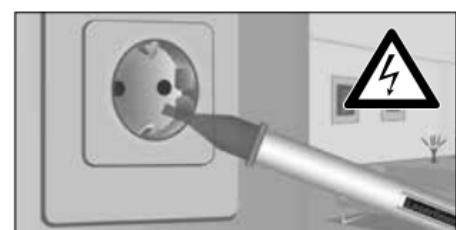
Setzen Sie die Detektorspitze auf den zu prüfenden Bereich (z.B. Kabel, Steckdose, etc.).
