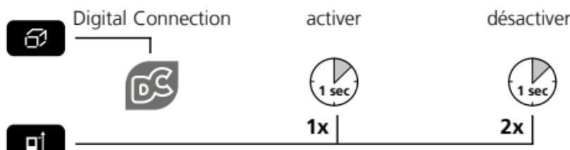
Le symbole Digital Connection apparaît après activation à l'écran (e). Si la fonction est active, un appareil mobile peut se connecter à l'appareil de mesure par l'intermédiaire d'une application.
