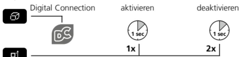
Das Digital Connection-Symbol erscheint nach Aktivierung im Display (e). Bei aktiver Funktion kann sich ein mobiles Endgerät mittels einer App mit dem Messgerät verbinden.
