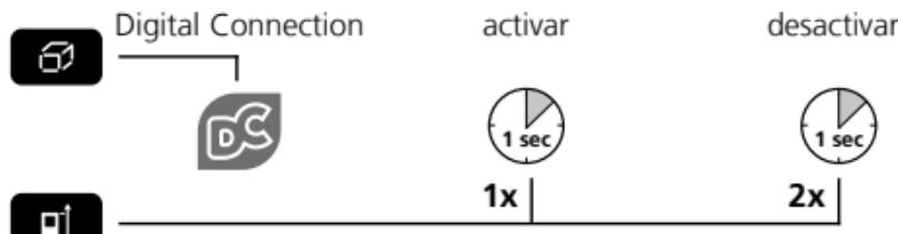
Después de su activación, el símbolo Digital Connection aparecerá en pantalla (e). Cuando la función está activa, cualquier dispositivo móvil se puede conectar al instrumento de medición por medio de la aplicación.
