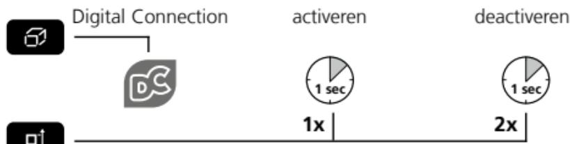
Na de activering verschijnt het Digital Connection-symbool op het display (e). Bij een actieve functie kan een mobiel eindtoestel door middel van een app met het meettoestel worden verbonden.
