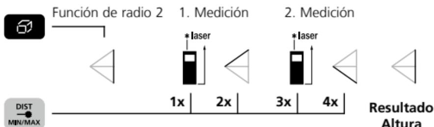
El resultado de medición se obtiene con el sensor de inclinación de 360°.
