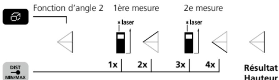
Le résultat de mesure est calculé par le capteur d'inclinaison 360°.
