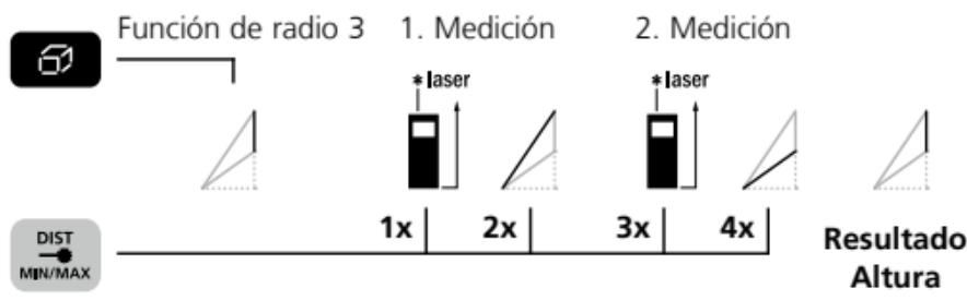
El resultado de medición se obtiene con el sensor de inclinación de 360°.
