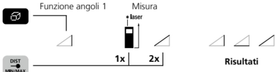
I risultati di misurazione vengono determinati automaticamente dal sensore di inclinazione a 360°.
