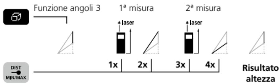
Il risultato di misurazione viene determinato automaticamente dal sensore di inclinazione a 360°.
