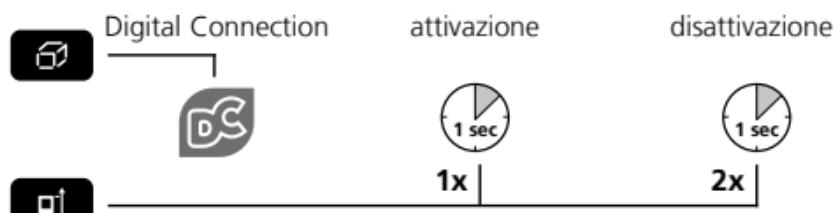
Dopo l'attivazione, il simbolo Digital Connection appare sul display (e). Attivando la funzione, un terminale mobile può connettersi con l'apparecchio di misurazione per mezzo di un'app.
