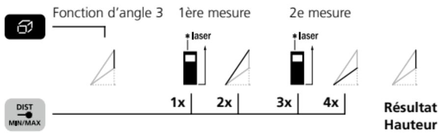
Le résultat de mesure est calculé par le capteur d'inclinaison 360°.
