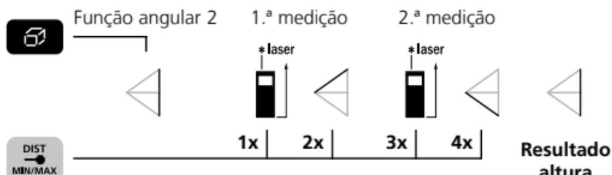
O resultado angular é calculado através do sensor de inclinação 360°.
