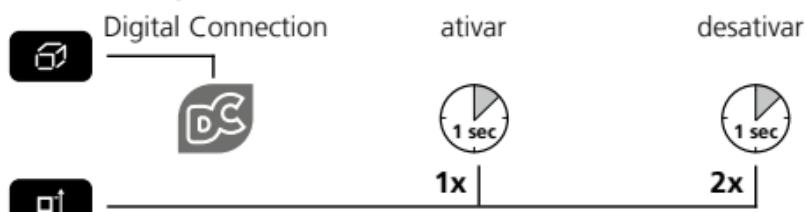
O símbolo Digital Connection aparece no visor (e) após a ativação. Com a função ativada é possível conectar um terminal móvel ao aparelho de medição através de uma App.
