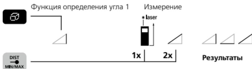
Результаты измерений определяются автоматически с помощью датчика наклона с диапазоном 360°.
