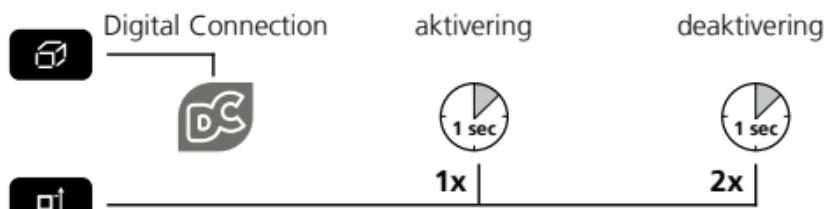
Digital Connection-symbolet dukker opp i displayet etter aktivering (e). Når funksjonen er aktivert, kan et mobilt sluttapparat kople seg til måleinstrumentet vha. en app.
