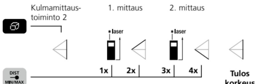
360° kallistusanturi laskee mittautuloksen.
