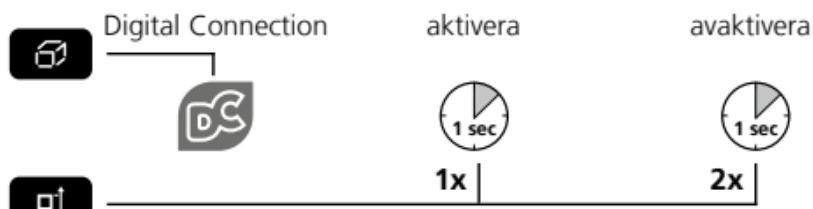
Digital Connection-symbolen visas efter aktivering på skärmen (e). Vid aktiv funktion kan en mobil slutenhet anslutas till mätapparaten med hjälp av en app.
