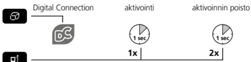
Digital Connection-kuvake näkyy aktivoimisen jälkeen näytössä (e). Kun toiminto on aktivoituna, voit ottaa yhteyden vastaanottavaan laitteeseen apuohjelmalla.
