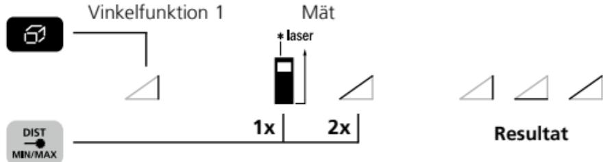
Mätrésultaten anges automatiskt med hjälp av en 360° lutningssensor.
