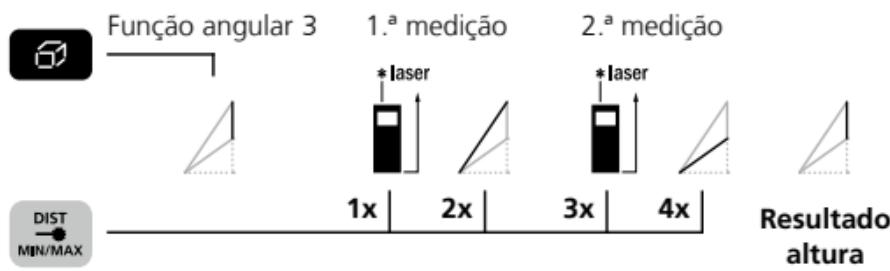
O resultado angular é calculado através do sensor de inclinação 360°.
