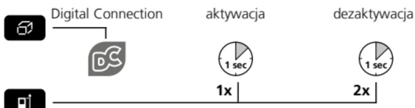
Symbol Digital Connection ukazuje się po aktywacji na wyświetlaczu (e). Przy aktywnej funkcji mobilne urządzenie końcowe może połączyć się z przyrządem pomiarowym za pomocą aplikacji.
