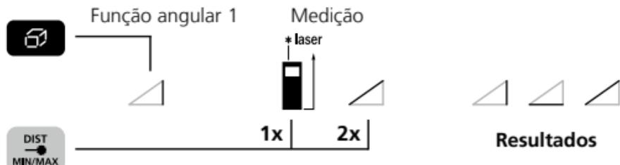
Os resultados de medição são calculados automaticamente através do sensor de inclinação 360°.
