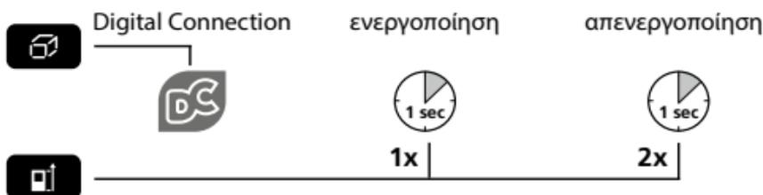
Το Digital Connection-σύμβολο εμφανίζεται μετά την ενεργοποίηση στην οθόνη (e). Με ενεργοποιημένη λειτουργία μπορεί να συνδεθεί μία κινητή τερματική συσκευή μέσω ενός App με τη συσκευή μέτρησης.
