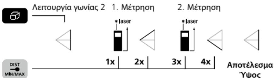
Το αποτέλεσμα της μέτρησης υπολογίζεται μέσω του αισθητήρα κλίσεων 360°.
