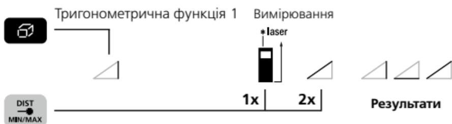
Результати вимірювань автоматично визначається датчиком кута нахилу з діапазоном регулювання 360°.
