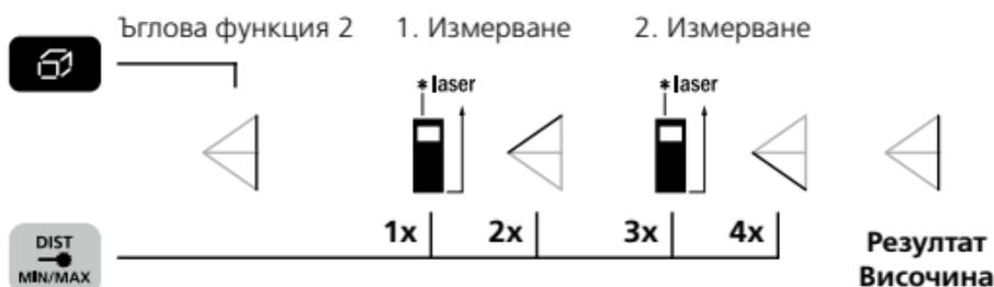
Резултатът от измерване се определя автоматично чрез сензора за наклон 360°.
