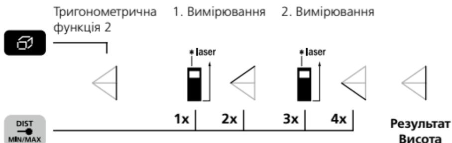
Результат вимірювання визначається датчиком кута нахилу з діапазоном регулювання 360°.
