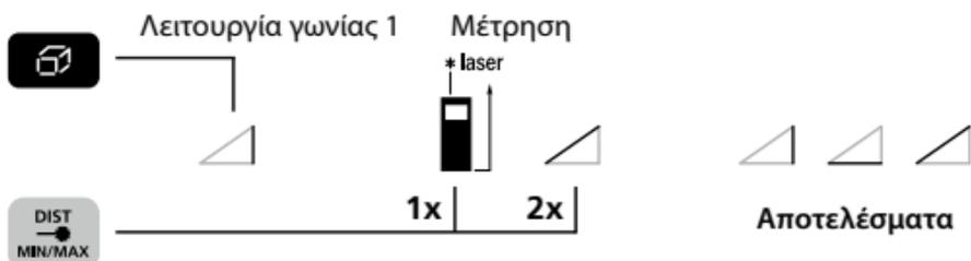
Τα αποτελέσματα της μέτρησης υπολογίζονται αυτομάτως μέσω του αισθητήρα κλίσεων 360°.
