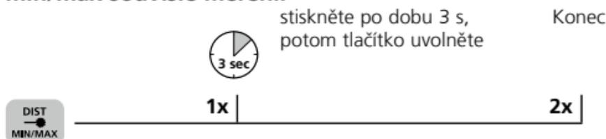
LC displej zobrazí největší hodnotu (max), nejmenší hodnotu (min) a aktuální hodnotu.
