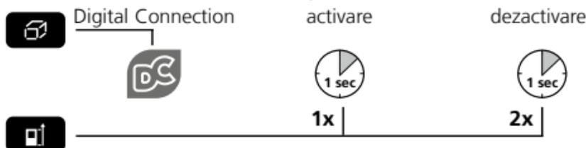
Simbolul Digital Connection apare pe afișaj imediat după activare (e). În cazul în care funcția este activată, un aparat final se poate conecta cu aparatul de măsură prin intermediul unei aplicații.
