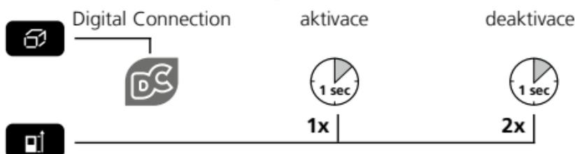
Po aktivaci se na displeji zobrazí symbol Digital Connection (e). Při aktivované funkci se mobilní koncové zařízení může pomocí aplikace připojit k měřicímu přístroji.
