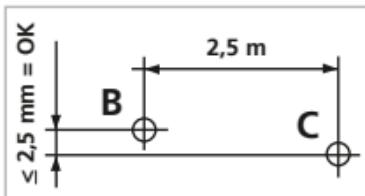
Verifique se a linha horizontal do ponto C se encontra a uma altura  $\pm 2,5$  mm do ponto B. Repita o processo, mas agora girando a cruz do laser para a esquerda.
