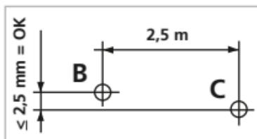
Zkontrolujte, jestli vodorovná čára od bodu C leží  $\pm 2,5$  mm ve stejně výšce s bodem B. Postup opakujte natočením doleva.
