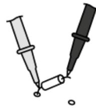
Si en la pantalla se visualiza „1“ en lugar del valor medido, esto indica bien que el rango de medición ha sido sobrepasado, bien que el circuito de medición no está cerrado o está interrumpido.
