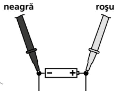
Tensiunea bateriei este afișată pe display. Citiți starea de încărcare a bateriei pe următoarea gradăție.
