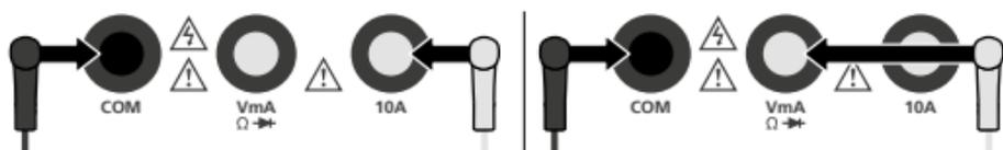
Завжди приєднуйте чорний вимірювальний щуп (-) до роз'єму COM. Для вимірювання сили току > 200 мА приєднуйте червоний щуп (+) до роз'єму 10 А. Для інших вимірювальних функцій червоний щуп приєднується до роз'єму VmAΩ→.
