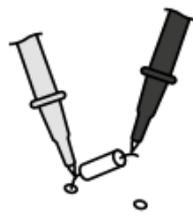
Если на экране отображается не полученное значение, а „1”, это означает, что либо замер диода происходит в запирающем направлении, либо диод поврежден.
