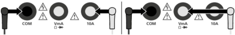
Černý měřicí hrot (-) se musí vždy připojit ke „zdiřce COM“. Při měření proudu > 200 mA se červený měřicí hrot (+) musí připojit ke „zdiřce 10 A“. Při všech ostatních měřicích funkcích se červený měřicí hrot musí připojit ke „zdiřce VmAΩ→“.
