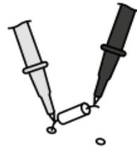
Pokud by se na displeji nezobrazila naměřená hodnota, ale „1“, je buďto překročený měřený rozsah nebo není uzavřený resp. je přerušovaný měřený obvod.
