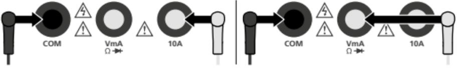
Siyah ölçüm ucu (-) daima „COM soketine” bağlanacaktır. Akım ölçümünde > 200 mA kırmızı ölçüm ucu (+) „10 A soketine” bağlanacaktır. Tüm diğer ölçüm fonksiyonlarında kırmızı ölçüm ucu (+) „VmAΩ- $\rightarrow$ ”-soketine” bağlanacaktır.
