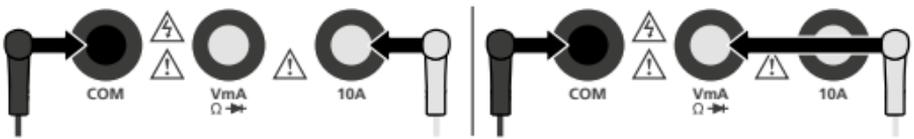
Vârful de măsurare negru (-) trebuie să se conecteze întotdeauna la „bucșa COM”. La măsurători ale curentului  $> 200\text{ mA}$ , vârful de măsurare roșu (+) se conectează la „bucșa 10A”. La toate celelalte funcții de măsurare, vârful de măsurare roșu se conectează la „bucșa  $VmA\Omega$ ”.
