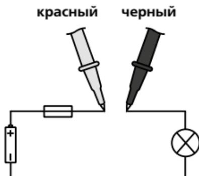
Токи силой свыше 2 А измерять не дольше 10 секунд на протяжении 15 минут. Иначе может быть поврежден прибор или измерительные наконечники.
