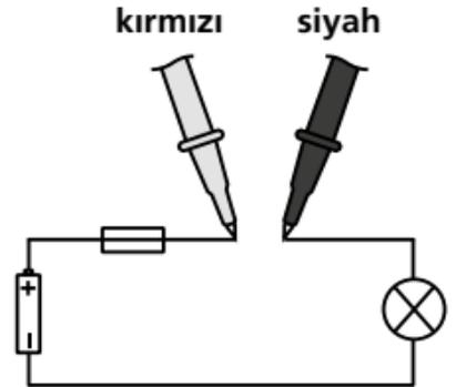
2 A üzeri akımları 15 dakika içinde 10 saniyeden uzun süre ölçmeyiniz. Aksi takdirde cihazın veya ölçüm uçlarının hasar görmesi söz konusu olabilir.
