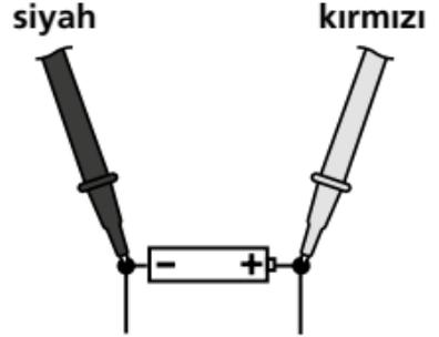
Bataryanın voltajı ekranda gösterilir. Batarya doluluk durumunu aşağıdaki skaladan okuyabilirsiniz.
