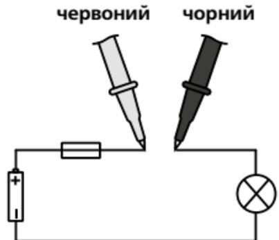
Забороняється вимірювати силу струму вище 2 А довше, ніж 10 секунд протягом 15 хвилин. Це може призвести до пошкодження приладу або вимірювальних щупів.
