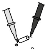
Якщо замість значення на дисплеї з'являється "1", то або діапазон вимірювань перевищено, або контур вимірювання не замкнутий або розімкнутий.
