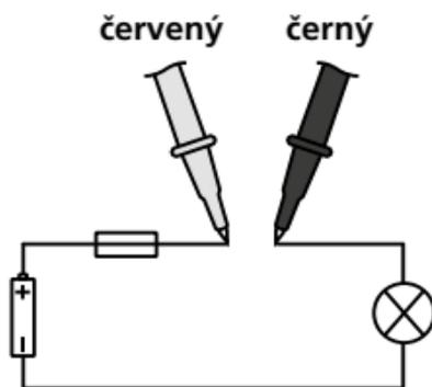
Proud větší než 2 A neměřte déle než 10 sekund během 15 minut. Mohlo by to způsobit poškození přístroje nebo měřicích hrotů.
