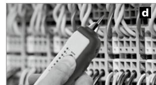
**Съвет 3:** Редуцирайте постепенно приемния сигнал с регулятора за сила на звука (18), за да локализирате по-добре търсения кабел. Търсеният кабел може да се локализира чрез разлики в силата на звука и се показва чрез най-яркото светене на индикацията за статус (19), сътв. най-високата сила на звука на сигнала.
