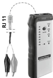
La această aplicație este necesar numai emițătorul. Clemele de cablu se conectează la conexiunea RJ 11, la obiectul de măsurat iar aparatul se comută în modul LAN-TEST. Pentru aceasta apăsați tasta MODE (3), până când se aprinde indicatorul de mod LAN-TEST (8) și pâlpâie indicatorul de stare LAN-TEST.
