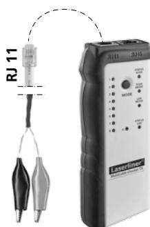
Ennél az alkalmazásnál csak az adóra van szükség. Kössze össze a kábelkapcsokat az RJ 11 csatlakozóval, csatlakoztassa a kábelkapcsokat a mérendő objektumhoz és kapcsolja a készüléket LAN-TESZT üzemmódba. Ehhez nyomja meg a (3) MODE nyomógombot, amíg a (8) LAN-TESZT üzemmódjelző nem világít és a LAN-TESZT állapotjelző villog.
