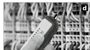
**Совет 3:** Постепенно снижать сигнал приема с помощью регулятора громкости (18), чтобы можно было лучше определить местонахождение искомого кабеля. Обнаружить местонахождение искомого кабеля можно за счет разности громкости; индикация осуществляется путем более яркого свечения индикаторов состояния (19) или более громкого сигнала.
