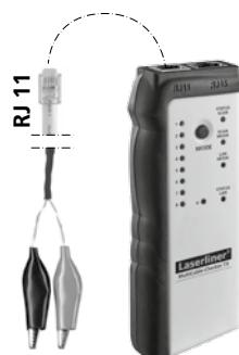
Для цієї мети потрібний лише передавач. З'єднайте кабельні клеми з роз'ємом RJ 11, підключіть кабельні клеми до об'єкту вимірювання і увімкніть на приладі режим LAN-тестування. Для цього натисніть кнопку режиму (MODE) (3), поки індикатор відображення режими LAN-TEST (8) почне світитися й індикатор відображення статусу LAN-TEST (9) блімати.
