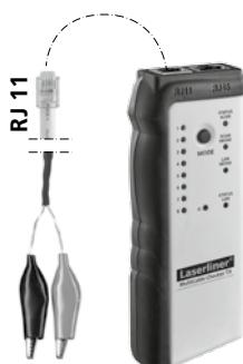
Στην εφαρμογή αυτή απαιτείται μόνο ο πομπός. Συνδέστε τους ακροδέκτες καλωδίων με τη σύνδεση RJ 11, συνδέστε τους ακροδέκτες καλωδίων στην κατάσταση LAN-TEST. Για τον σκοπό αυτόν πατήστε το πλήκτρο MODE (3), έως ότου ανάψει η ένδειξη λειτουργίας LAN-TEST (8) και αρχίσει να αναβοσβήνει η ένδειξη κατάστασης LAN-TEST.
