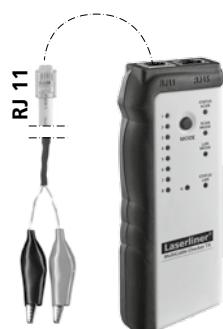
V prípade tohto použitia je potrebný iba vysielač. Káblové svorky prepojiť s prípojkou RJ 11, káblové svorky pripojiť na meraný objekt a prístroj prepnúť do režimu LAN-TEST. Za tým účelom stlačte tlačidlo MODE (3), kým nesvieti indikátor režimu LAN-TEST (8) a nebliká indikátor stavu LAN-TEST.
