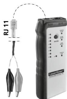
Při tomto použití je zapotřebí jen vysílač. Připojte svorky kabelu k přípojce RJ 11 a k měřenému objektu a zapněte přístroj v LAN-TESTOVACÍM režimu. K tomu stiskněte tlačítko MODE (3), dokud se nerozsvítí indikátor režimu LAN-TEST (8) a nebude blikat indikátor stavu LAN-TEST.
