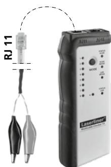
В этом режиме требуется только передатчик. Соединить кабельные зажимы с разъемом RJ 11, подсоединить кабельные зажимы к объекту измерений и включить прибор в контрольный режим LAN-TEST. Для этого нажимать кнопку режима MODE (3) до тех пор, пока не загорит индикатор режима тестирования LAN-TEST (8) и не начнет мигать индикатор состояния тестирования LAN-TEST.
