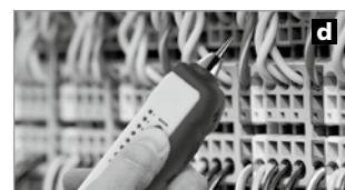
**Tip 3:** Pomocou regulátora hlasitosti (18) postupne zredukujte prijímaný signál, aby sa dal lepšie lokalizovať hľadaný kábel. Poloha hľadaného kabla sa môže určiť pomocou rozdielov intenzity zvuku a zobrazí sa aj jasnejším žiareniom indikátora stavu (19) alebo maximálou hlasitosťou signálu.
