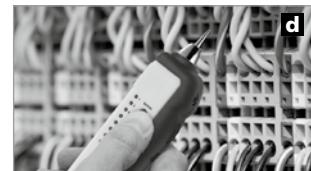
**3. padoms:** uztverto signālu pakāpeniski samaziniet ar skaļuma regulatoru (18), lai varētu labāk lokalizēt meklējamo kabeli. Meklējamo kabeli var atrast pēc skaņas stipruma atšķirībām, un tas tiek uzrādīts ar statusa indikatora (19) visgaļāko mirdzēšanu vai visskaļāko signālu.
