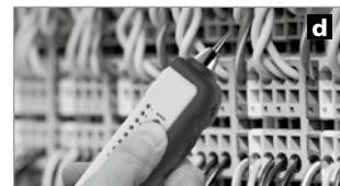
**Tip 3:** Regulátorem hlasitosti (18) po krocích snižuje příjmový signál, abyste hledaný kabel lépe lokalizovali. Hledaný kabel lze lokalizovat pomocí rozdílů hlasitosti, a je indikován nejasnějších rozsvícením indikátoru stavu (19) resp. nejvýšší hlasitostí signálu.
