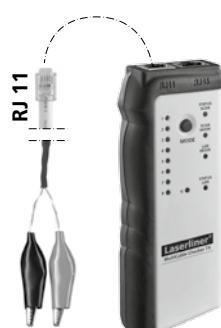
Šim pielietojumam ir vajadzīgs tikai raidītājs. Kabeļa spailes savienojet ar RJ 11 ligzdu, pievienojet kabeļa spailes pie mērāmā objekta un ieslēdziet ierīci LAN-TEST režīmā. Šim nolūkam spiediet MODE taustiņu (3), kamēr LAN-TEST režīma indikators (8) deg nepārtraukti un LAN-TEST statusa indikators mirgo.
