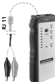
При това приложение е необходим само предавателят. Свържете кабелните клеми с RJ 11 извода, присъединете кабелните клеми към измервания обект и включете уреда в режим LAN-TEST. За целта натискайте бутона MODE (3), докато свети индикаторът на режима LAN-TEST (8) и индикаторът на статуса LAN-TEST мига.
