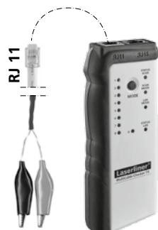
Pri tej uporabi potrebujete samo oddajnik. Kabelske sponke povežite s priključkom RJ 11, kabelske sponke priključite na merilni objekt in napravo preklopite v način LAN-TEST. Pri tem pritiskajte tipko MODE (3), dokler ne zasveti prikaz načina LAN-TEST (8) in začne utripati prikaz stanja LAN-TEST.
