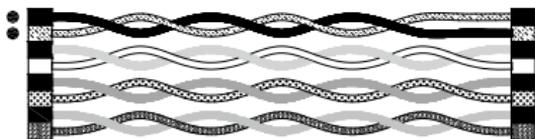
Je-li indikována chyba zapojení **záměna**, jsou nesprávně k sobě připojeny piny **jednoho** páru vodičů.
