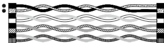
Ak existuje chyba zapojenia **zámena**, sú kolíky **jedného** páru drôtov spojené navzájom nesprávne.
