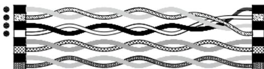
În cazul în care există o eroare de cablare **încrucișare** înseamnă că pinii de la **două** perechi de fire au fost interconectați greșit.
