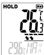
Indicación de la temperatura por infrarrojos (en todos los modos de medición)
