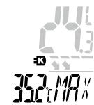
! Wartości min/max są usuwane przy zmianie trybu oraz włączaniu/wyłączaniu urządzenia.
