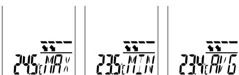
Le modalità Max/Min/Avg si riferiscono alla temperatura degli infrarossi e indicano rispettivamente la temperatura massima, minima o media degli infrarossi. I valori massimi, minimi e medi vengono determinati durante la misurazione in corso con il tasto di avvio premuto (9). Quando si avvia una nuova misurazione o premendo il tasto di avvio (9) il valore viene cancellato e calcolato di nuovo.
