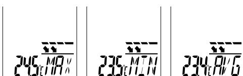
Tryby Max/Min/Avg odnoszą się do temperatury podczerwieni i wskazują kolejno temperaturę maksymalną, minimalną lub temperaturę średnią podczerwieni. Wartości Max/Min/Avg są ustalane podczas trwającego pomiaru przy naciśniętym przycisku włączenia (9). Po rozpoczęciu nowego pomiaru bądź naciśnięciu przycisku włączenia (9) wartość jest usuwana i obliczana na nowo.
