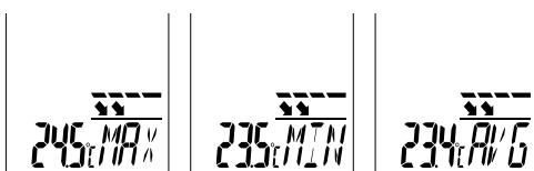
Os modos Max/Min/Avg referem-se à temperatura por infravermelhos e indicam respectivamente a temperatura por infravermelhos máxima, mínima ou média. Os valores Max/Min/Avg são calculados durante a medição corrente com o gatilho pressionado (9). Ao iniciar uma medição nova ou ao pressionar o gatilho (9), o valor é eliminado e novamente calculado.”
