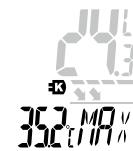
! Minimi- ja maksimiarvot poistetaan käyttötilaa vaihdettaessa ja laite pääälle / pois päältä kytettäessä.
