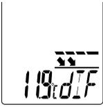
Detta läge refererar till infraröd-temperatur och beräknar differensen mellan maximal och minimal infraröd-temperatur för en löpande mätning. När man startar en ny mätning resp. trycker på utlösaren (9) raderas värdet och beräknas på nytt.
