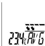
Lägena Max/Min/AVG refererar till infraröd-temperatur och visar maximal, minimal eller genomsnittlig infraröd-temperatur. Värdena Max/Min/AVG meddelas under löpande mätning när man trycker på utlösaren (9). När man startar en ny mätning resp. trycker på utlösaren (9) raderas värdet och beräknas på nytt.
