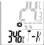
I läget kontakt-temperatur T-K slås instrumentet på så snart som en temperatursensor (K-typ) ansluts. Medan temperatursensorn är ansluten, slås inte instrumentet av automatiskt vid en batteriladdning på minst 15%.
