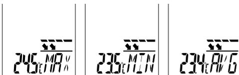
Modiene Maks. / min. / AVG er relatert til infrarød-temperaturen og viser i hvert tilfelle maksimum, minimum eller gjennomsnittlig infrarød-temperatur. Maks. / min. / AVG-verdiene beregnes under den løpende målingen mens utløseren (9) holdes trykket. Ved start av en ny måling eller ved å trykke på utløseren (9) slettes verdien, og den beregnes på nytt.
