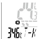
Прибор автоматически переключается в режим контактного измерения температуры T-K, как только к нему подсоединяется датчик температуры (тип K). При подсоединенном датчике температуры прибор не выключается автоматически до тех пор, пока заряд батареи не упадет ниже 15%.
