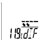
Этот режим относится к инфракрасному измерению температуры и вычисляет разность между максимальной и минимальной температурой, определенной в инфракрасной области спектра в текущем измерении. При запуске нового измерения или в результате нажатия кнопки пуска (9) значение удаляется и вычисляется заново.
