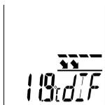
Цей режим відноситься до вимірювання температури за інтенсивністю теплового випромінювання та визначає різницю між максимальною та мінімальною температурою поточного вимірювання за інтенсивністю теплового випромінювання. З початком нового вимірювання або після натискання спускової кнопки (9) показник буде видалено та розраховано повторно.
