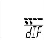
4. Різниця температури за інтенсивністю теплового випромінювання (Max / Min)
