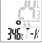
Bir sıcaklık sensörü (K tipi) bağlandığında, cihaz otomatik olarak T-K temas sıcaklık moduna geçer. Sıcaklık sensörü bağlı durumdayken cihazın batarya şarjı en az % 15 ise cihaz otomatik olarak kapanmaz.
