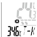
Прилад автоматично вмикає режим контактного вимірювання температури T-K після під'єднання датчика температури (K-тип). Після підключення датчика температури пристрій не вимикається автоматично, якщо заряд акумулятора становить щонайменше 15%.
