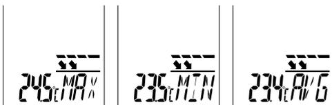
Режимы Max/Min/AVG относятся к измерению температуры в инфракрасной области спектра и выводят на экран, соответственно, максимальную, минимальную или среднюю температуру, определенные этим способом. Значения Max/Min/AVG определяются во время текущего измерения при нажатой кнопке пуска (9). При запуске нового измерения или в результате нажатия кнопки пуска (9) значение удаляется и вычисляется заново.
