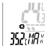
**!** Мин./макс. значения удаляются при смене режимов, а также при включении / выключении прибора.
