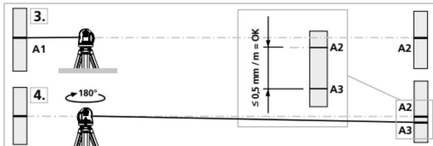
! Jos A2 ja A3 ovat toisistaan etäämmällä kuin  $0,5 \text{ mm} / \text{m}$ , on säätö tarpeen. Ota sitä varten tarvittaessa yhteys laitteen jälleenmyyjään tai suoraan UMAREX-LASERLINER-huolto-osastoon.
