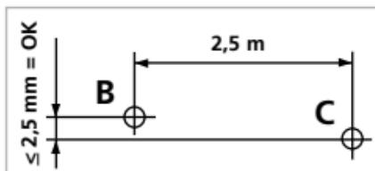
Поворачивайте прибор, пока лазерный крест не сдвинется на 2,5 м вправо. Сделайте отметку С. Расстояние между горизонтальными линиями, проведенными через эти две точки, не должно превышать ± 2,5 мм. Повторите замеры, поворачивая прибор влево.
