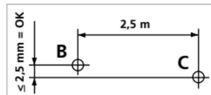
лазерний хрест прибл. на 2,5 м праворуч і помітити крапку C. Перевірити, чи горизонтальна лінія пункту C знаходитьться на тій же висоті  $\pm 2,5$  мм, що і пункту B. Повторити процес з повертанням ліворуч.
