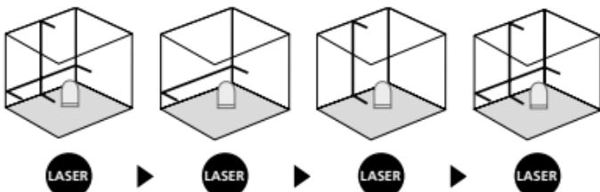
Pro horizontální a vertikální nivelači musí být uvolněná transportní pojistka. LED svítí nepřerušovaně zeleně. Jakmile se přístroj nachází mimo rozsah automatické nivelačce  $5^\circ$ , blikají laserové linie a LED se rozsvítí červeně. Umístěte přístroj tak, aby se nacházel uvnitř rozsahu nivelačce. LED se opět rozsvítí zeleně a laserové linie svítí nepřerušovaně.
