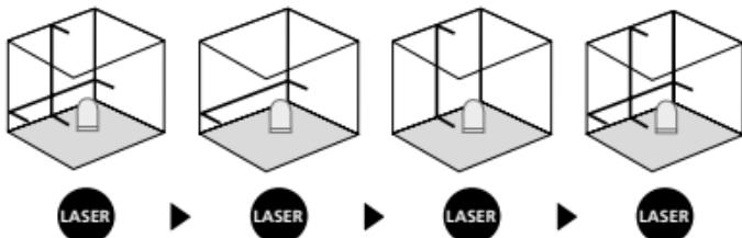
! Для горизонтального и вертикального нивелирования необходимо снять с блокировки фиксатор для транспортировки. Постоянно горит зеленый светодиод. Как только прибор окажется за пределами автоматического диапазона нивелирования, равного  $5^\circ$ , лазерные линии и светодиод начинают гореть красным цветом. Позиционировать прибор так, чтобы он находился в пределах диапазона нивелирования. Светодиод снова изменяет свой цвет на зеленый, а лазерные линии светятся постоянно.
