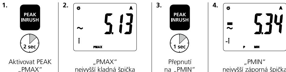
Krátce stiskněte tlačítko PEAK / INRUSH, abyste přepnuli mezi PMAX a PMIN. Chcete-li se vrátit k běžnému provozu, držte stisknuté tlačítko PEAK / INRUSH tak dlouhou, dokud se na LCD displeji neobjeví zobrazení „AUTO“.
