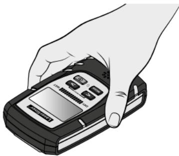
Вимірювальній пристрій завжди слід тримати рівно та притискати рівномірно (див. малюнок)
