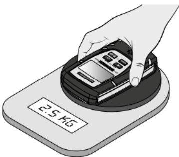
Sensör pedleri komple ölçüm malzemesinin üzerine yerleştirin ve cihazı yakla. 2,5 kg baskı ile ölçüm alanına bastırın.
