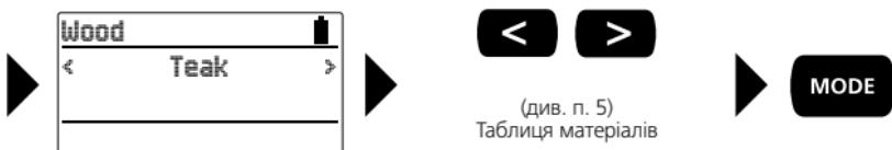
Після вибору матеріалу вгорі на дисплеї з'явиться обраний режим, а внизу – відповідний матеріал. Щойно виміряне значення в % вологості матеріалу можна буде зчитати посередині дисплея.
