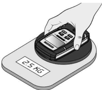
Așezați padurile senzitive complet pe materialul de măsurat și apăsați-le cu o presiune de cca. 2,5 kg pe suprafața de măsurare.
