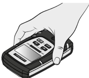
Měřicí přístroj držte vždy stejně a přitlačujte (viz obrázek)
