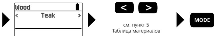
После выбора материала в верхней части экрана появляется выбранный режим, а внизу - соответствующий материал. Текущий результат измерений в % влажности материала можно увидеть в центре экрана.
