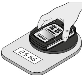
Уложить подложки реобразователей целиком на анализируемый материал и прижать прибор к исследуемой поверхности с усилием примерно 2,5 кг.
