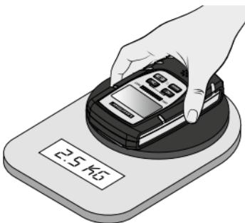
Повністю прикладти сенсорні накладки до вимірюваної поверхні і притиснути пристрій до вимірювальної поверхні з зусиллям натискання близько 2,5 кг.
