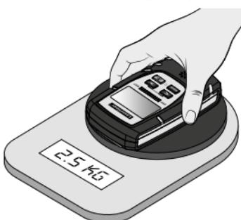
Vodivé kontakty úplně položte na měřený materiál a přístroj tlakem cca 2,5 kg zatlačte na měřenou plochu.
