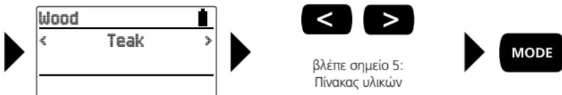
Μετά την επιλογή του υλικού εμφανίζεται επάνω στην οθόνη ο επιλεγμένος τρόπος λειτουργίας, κάτω το αντίστοιχο υλικό. Η τρέχουσα τιμή μέτρησης σε % υγρασίας υλικού μπορεί να διαβαστεί στο μέσον της οθόνης.
