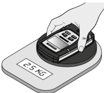
Pločice senzora potpuno postavite na materijal koji se mjeri i pritisnite uređaj na mjernu površinu pritiskom od oko 2,5 kg.
