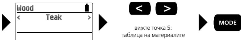
След избора на материал горе в дисплея се появява избраният режим, а долу - съответният материал. Текущата измерена стойност в % влага на материала може да се отчете в средата на дисплея.
