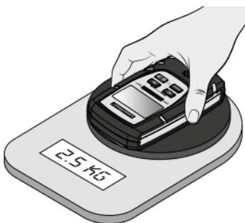
Τοποθετήστε τα Sensor Pads επάνω στο υλικό μέτρησης και πιέστε τη συσκευή με περ. 2,5 kg πίεση επάνω στην επιφάνεια μέτρησης.
