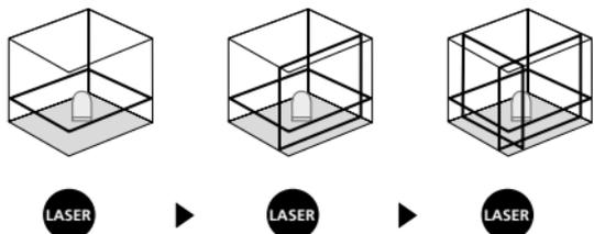
**!** Per il livellamento orizzontale e verticale si deve allentare la sicura di trasporto. Non appena l'apparecchio si trova al di fuori del campo di livellamento automatico di 2,5°, le linee laser iniziano a lampeggiare. Posizionare l'apparecchio in modo che si trovi all'interno del campo di livellamento.
