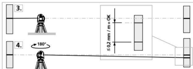
**!** Quand A2 et A3 sont distants de plus de 0,2 mm / m l'un de l'autre, un réglage de l'appareil est nécessaire. Prenez contact avec votre revendeur ou appelez le service après-vente de UMAREX-LASERLINER.
