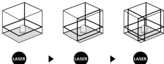
**!** Il est nécessaire de dégager le blocage de transport pour procéder au nivellements horizontal et vertical. Les lignes laser clignotent dès que l'appareil est en dehors de la plage de nivellement automatique de 2,5°. Positionner l'instrument de manière à ce qu'il soit dans la plage de nivellement.
