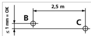
**!** Należy regularnie sprawdzać kalibrację przed użyciem, po zakończeniu transportu i po dłuższym przechowywaniu.
