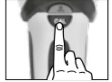
Kalibrasyon esnasında cihazı havaya kaldırıp tutarsanız maksimum cihaz hassasiyetini elde edebilirsiniz. Bu yöntem METAL ve AC-SCAN ölçümlerinde yer yer mantıklı olabilir.
