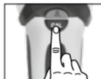
A sensibilidade máxima do aparelho é alcançada quando o aparelho é mantido no ar durante a calibragem. Este processo por vezes pode ser útil para as medições METAL e AC-SCAN.
