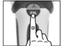
Enheten når sin maximala känslighet, när den hålls i luften under kalibreringen. Det kan vara motiverat vid METAL- och AC-SCAN-mätningar.
