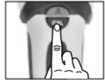
Laitteeseen saadaan suurin mahdollinen herkkyys, kun pidät laitteen kalibroinnin aikana ilmassa. Tämä saattaa joskus olla järkevää METAL- ja AC-SCAN-mittauksia tehtäessä.
