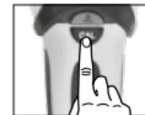
Максимальної чутливості прилад досягає, якщо під час калібрування його тримати в повітрі. Інколи це може мати сенс від час вимірювань в режимах пошуку металу (METAL-SCAN) або напруги змінного струму (AC-SCAN).
