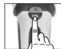
Максимальная чувствительность прибора достигается в том случае, когда прибор во время калибровки удерживается в воздухе. Это может быть целесообразно в отдельных случаях при измерениях в режимах METAL и AC-SCAN.
