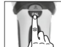
Maximální citlivosti přístroje se docílí, když se přístroj při kalibraci drží ve vzduchu. Může to být místa účelné u měření METAL- a AC-SCAN.
