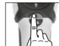
**AC-SCAN:** локалізування електропроводки під напругою безпосередньо під неметалевими обшивками.
