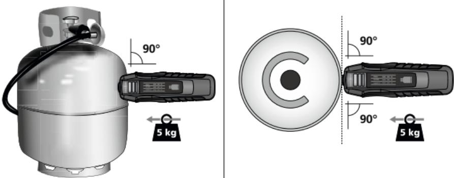
Měřicí hlavici přiložte kolmo k povrchu válce a v této poloze přitlačte.
