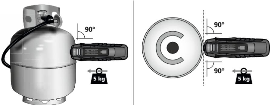
Capul de măsurare se poziționează vertical pe suprafața cilindrului și se apasă ușor.
