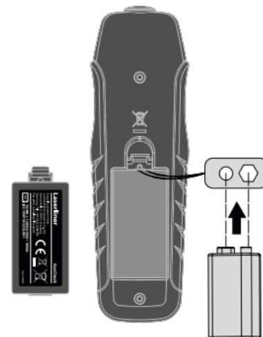
**!** Přístroje je po vložení baterií přímo připraven k provozu. Nemá žádný vypínač a je tudíž vždy aktivní.
